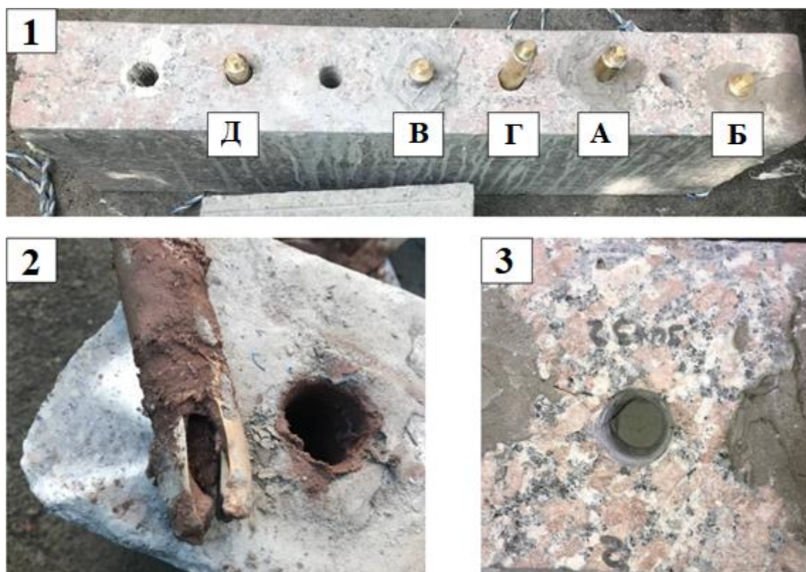
Рисунок 3.19 – Установка экспериментальных образцов скальных центров в гранитный блок. 1 – опытные образцы центров А, Б, В, Г, Д в скважинах, 2 – эффект скручивания нижней части центра в результате использования клина конусовидной формы, 3 – остатки каменной пыли в скважине
