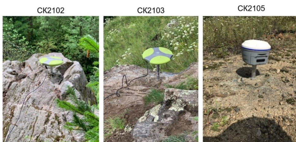
Рис. 3.22 – Общий вид установленных скальных геодезических центров во время выполнения ГНСС-измерений
