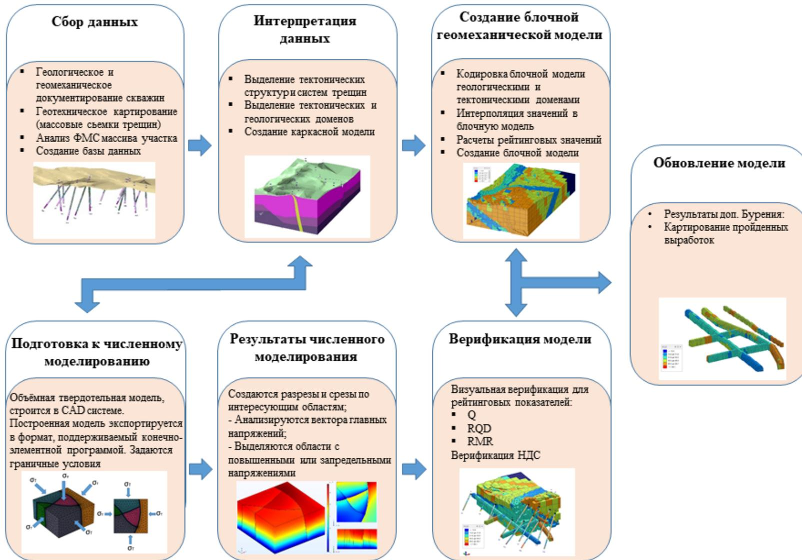
Рисунок 1.5 – Состав геомеханической модели в приложении к задаче захоронения высокоактивных РАО
