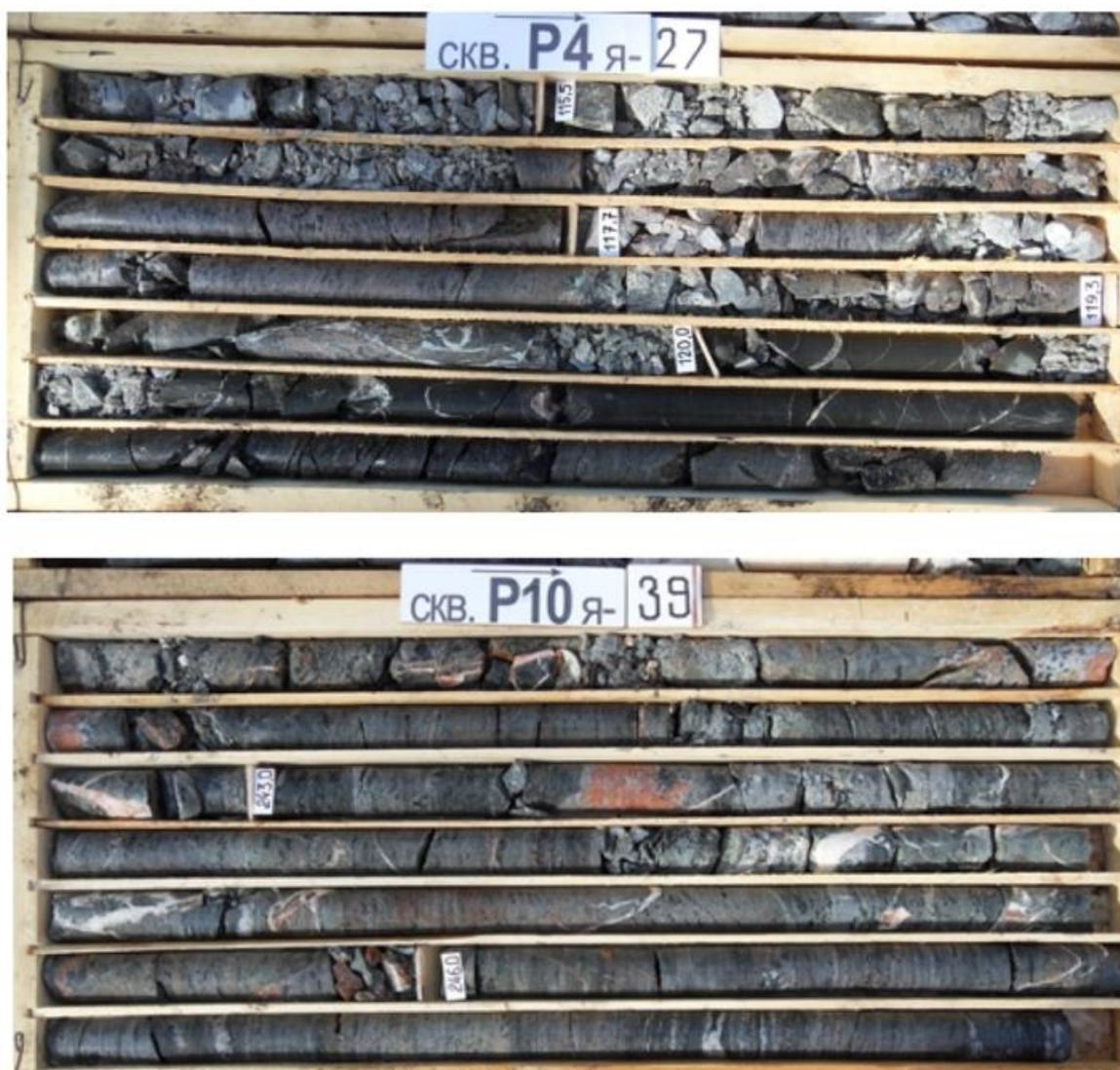
Рисунок 3.7 – Интервалы развития зон дробления в керне буровых скважин P-4 и P-10 [125]
