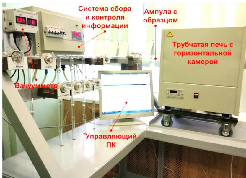
Рисунок 2.5 – Внешний вид установки газозатравки
