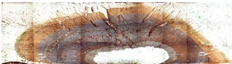
Рисунок 1.32 - Внешний вид излома сквозной трещины, образованной по механизму ЗГР, в трубе давления CANDU из сплава Zr-2,5Nb (распространение трещины от внутренней к внешней поверхности, снизу-вверх) [133]
