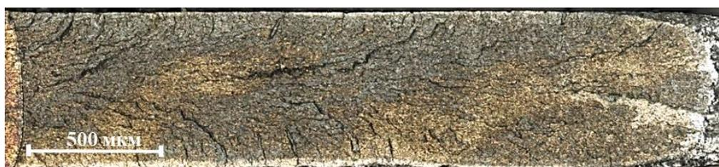
Рисунок 5.6 – Трещина ЗГР в образце из сплава Э110опт после испытания по определению  $K_{II}$  при 150°C (рост трещины слева направо)
