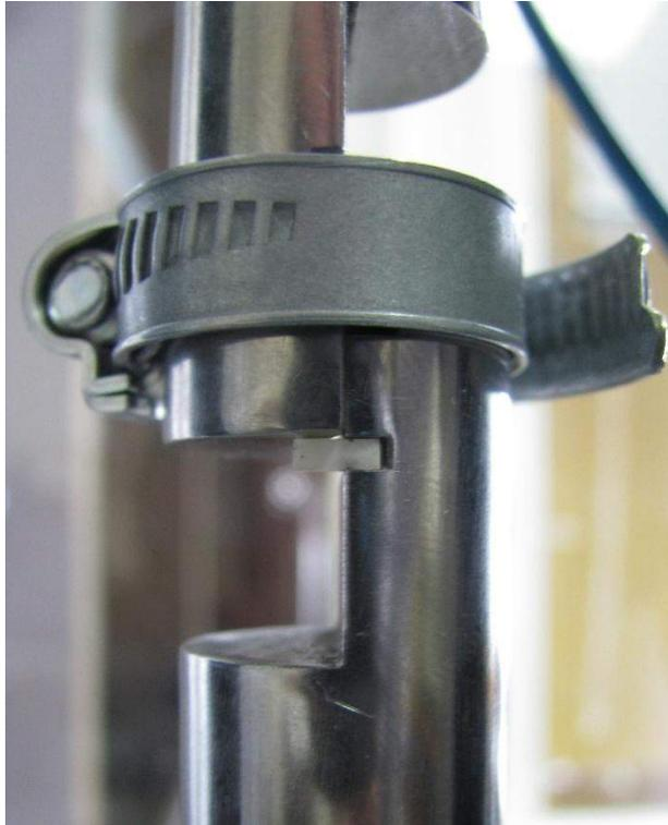
Рисунок 15 – Крепление образца для испытания на сдвиг в захватах.
