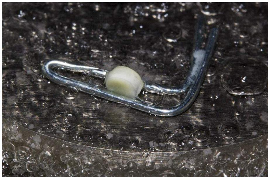
Рисунок 17 – Приспособление предотвращающее опрокидывание образца при диаметральном сжатии из-за кипения азота.
