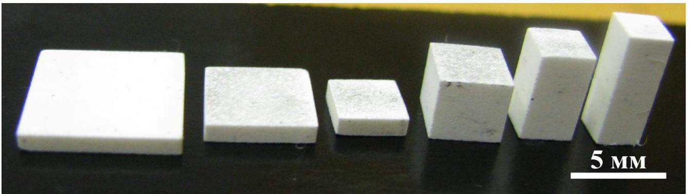
Рисунок 102 – Образцы из оксида алюминия с различным  $d/h$  отношением для сжатия, группы №62-67.
