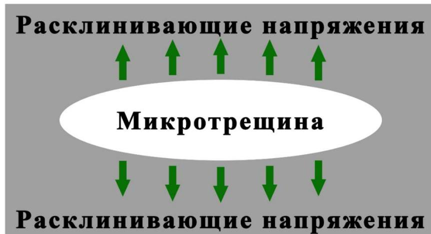
Рисунок 77 – Схема распределения напряжений в порообразной трещине.
