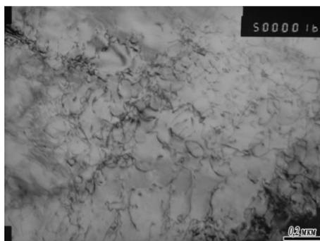
Рисунок 87 – Плотность дислокаций в феррите, образец от рулона С390П (В)-2 , ПЭМ, светлое поле, х50000
