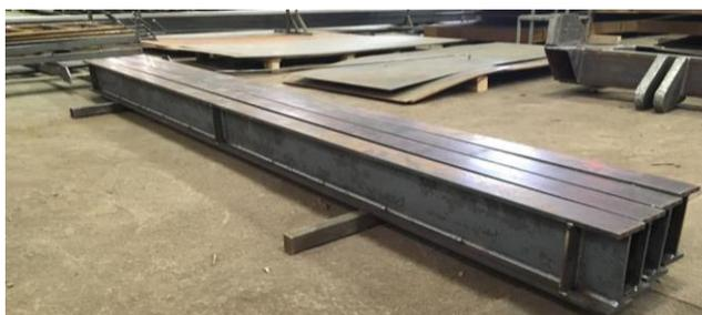
Рисунок 96 – Общий вид экспериментальных балок для огневых испытаний, изготовленных из проката С390П
