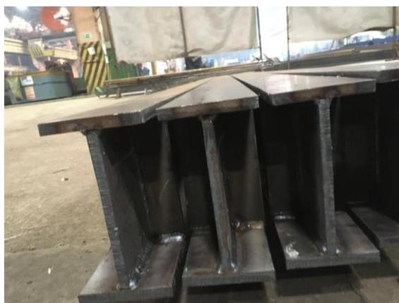
Рисунок 95 – Конфигурация экспериментальных балок для огневых испытаний, изготовленных из проката С390П
