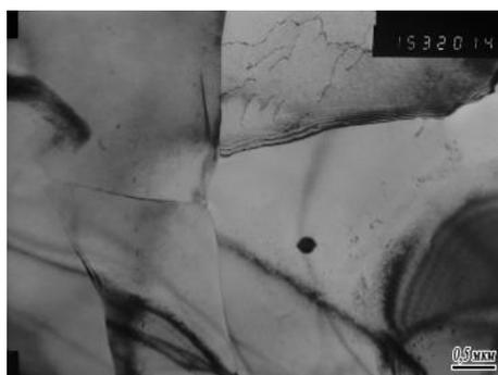
Рисунок 48 – Полиэдрический феррит в структуре плавки 2-2 (Ti+Mo), ПЭМ, светлое поле, x15000
