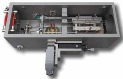
Рисунок 26 – Закалочно-деформационном дилатометре DIL 805 A/D
