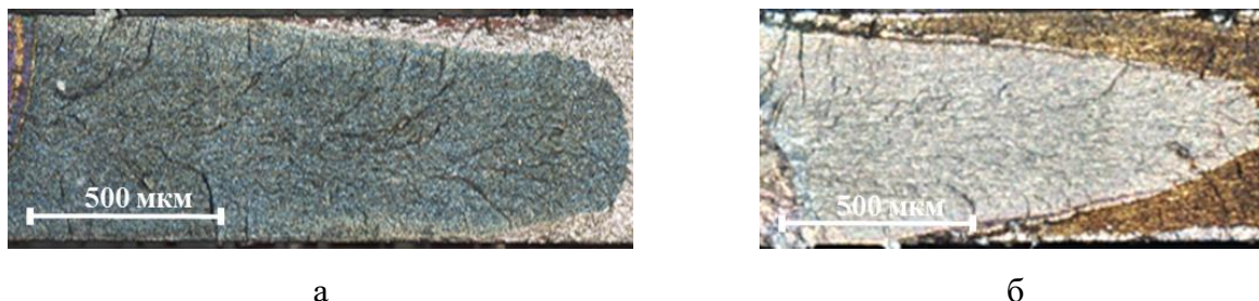
Рисунок 12 – «Туннельный» эффект формы трещин ЗГР в испытаниях на K_{II} при температурах выше температурного максимума для скорости ЗГР: а - Э635М (282°C, K_{II} = 9,7 \text{ МПа} \cdot \sqrt{\text{м}} ); б – Zircaloy-4 (298°C, K_{II} = 18,2 \text{ МПа} \cdot \sqrt{\text{м}} )
