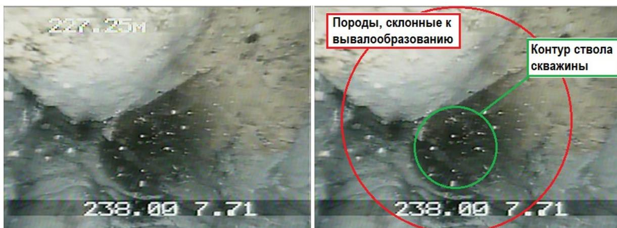
Рисунок 3.7 – Участок ствола скважины, склонный к вывалообразованию [108]
