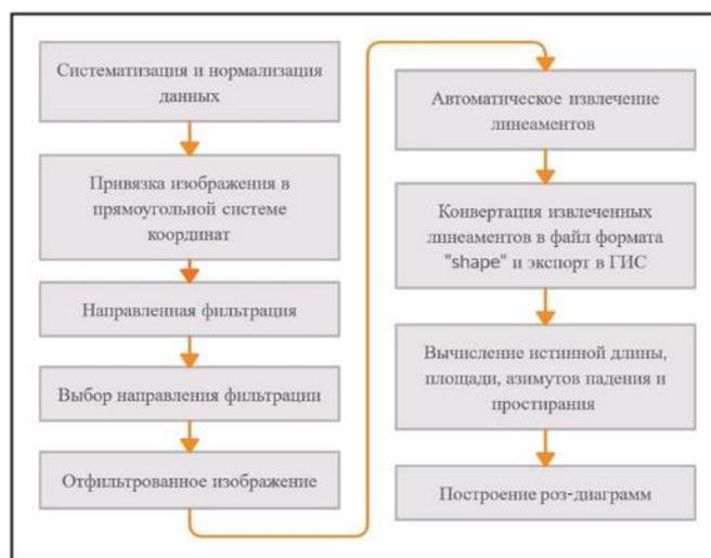
Рисунок 2.15 – Алгоритм обработки панорамных изображений [108]
