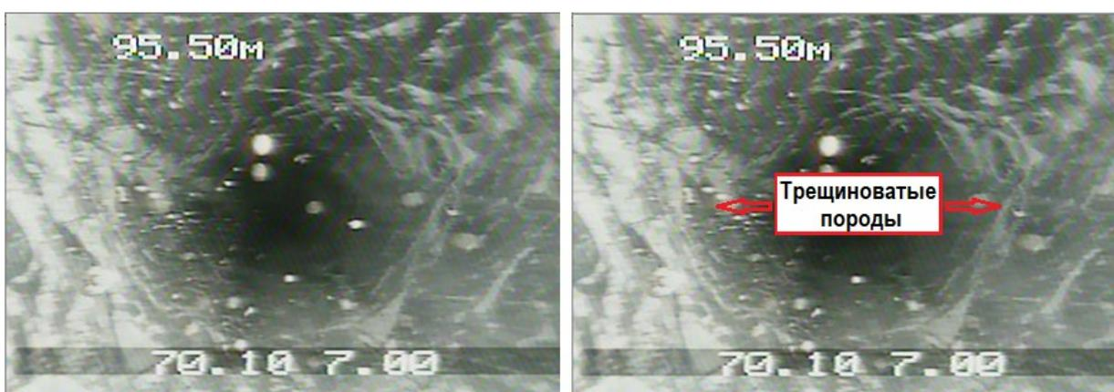
Рисунок 3.8 – Участок ствола скважины, проходящий через зону повышенной трещиноватости массива [108]
