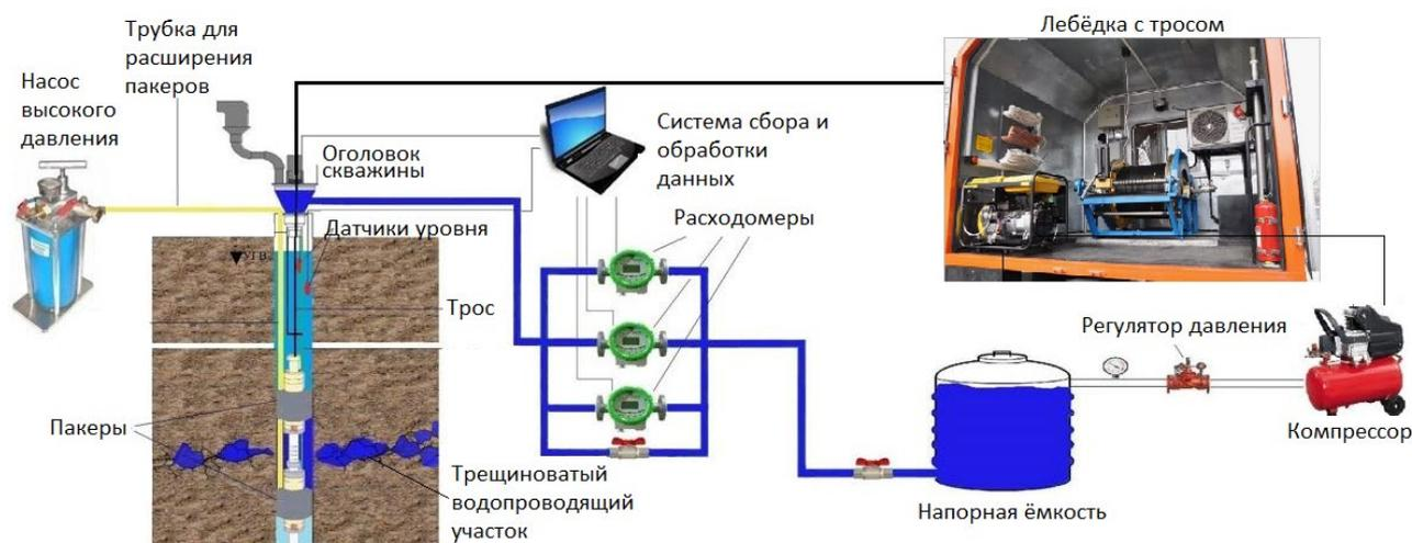
Рисунок 4.3 – Схема оборудования скважины для поинтервальных исследований
