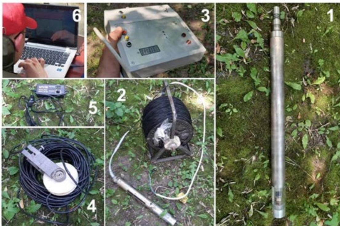
1 – скважинный видеозонд, 2 – лебедка с кабелем ГПСМПО 2х1,0 длиной 700 м и винтовым геофизическим разъемом; 3 – каротажный блок; 4 – блок-баланс с счётчиком глубины погружения видеозонда; 5 – зарядное устройство; 6 – ноутбук спредустановленным программным обеспечением (Модуль 1, Модуль 2, Модуль 3)
