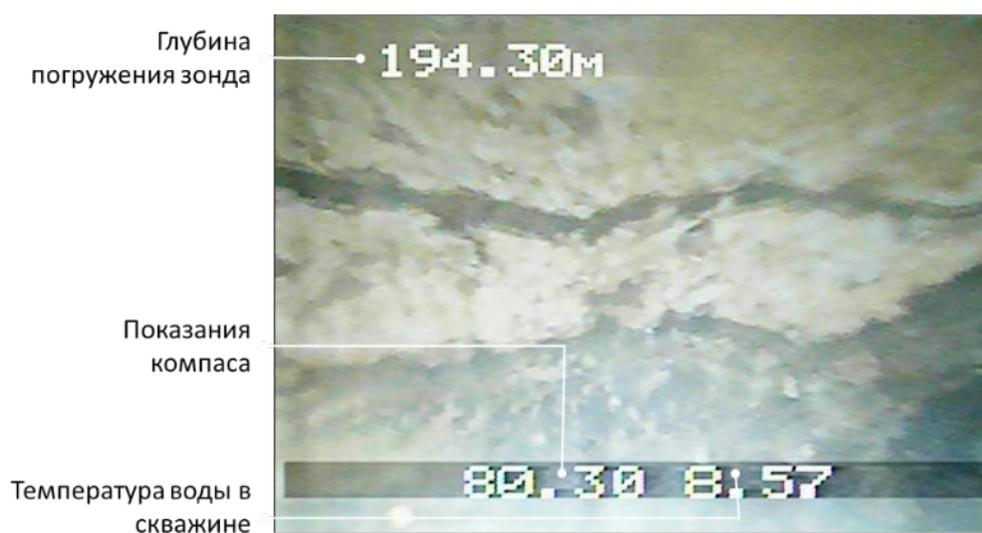
Рисунок 2.7 – Пример отображения показаний электронного компаса на изображении, передающемся с камер зонда (боковая камера)
