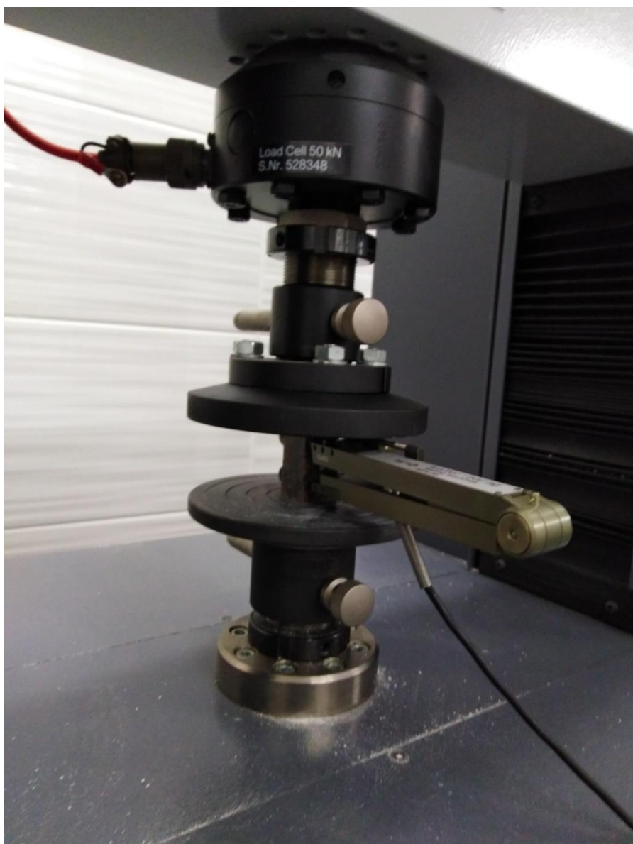
Рисунок 2.3 – Система образец горной породы – аксиальный экстензометр MFA–25/12 – сжимающее устройство
