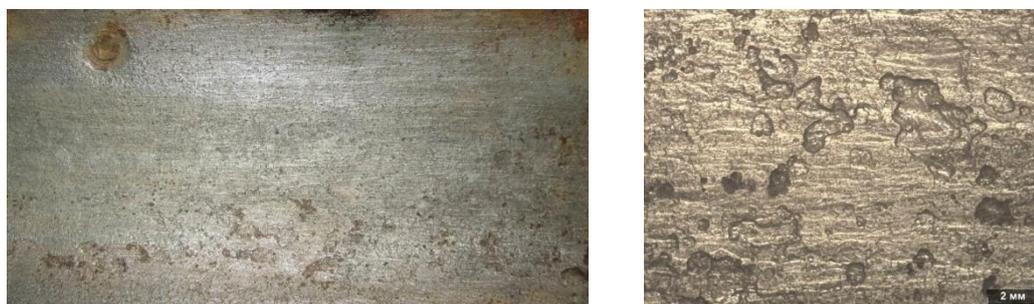
Рисунок 6.18 – Внутренняя поверхность трубы после 2 лет эксплуатации в байпасе
