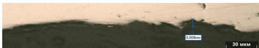
Рисунок 6.16 – Микронеровности на внутренней поверхности трубы, соответствующих коррозионному износу
