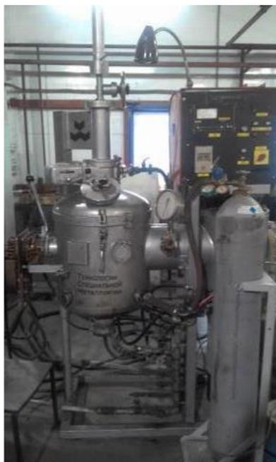
Рисунок 2.4 Общий вид вакуумной индукционной печи
