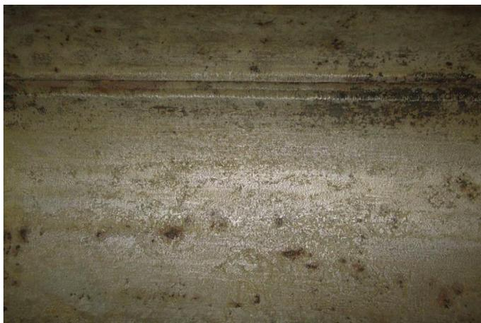
Рисунок 6.15 – Внутренняя поверхность трубы после эксплуатации в байпасе в течение года, очищенная от налета в зоне сварного шва.
