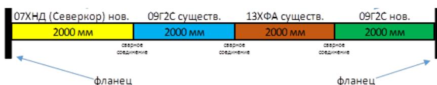
Рисунок 6.19 – Схема установки испытываемых образцов на скважине Вт\_004 Большетирского месторождения
