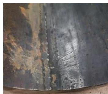
Рисунок 6.21 – Нижняя образующая трубы после зачистки
