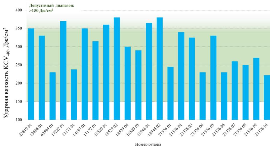
Рисунок 6.7 – Распределение значений низкотемпературной ударной вязкости для рулонного проката CORDIS (07XHD)
