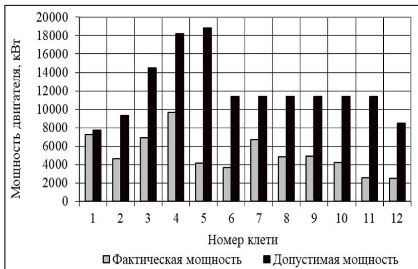
Рисунок 5.22 – Распределение значений мощности на валу двигателя по клетям НППС 2000
