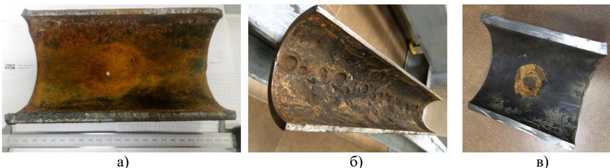
Рисунок 1.1 – Вид локальной коррозии промысловых труб: а – труба  $\text{Ø}114 \times 10$  мм; б – труба  $\text{Ø}89 \times 6$  мм; в – труба  $\text{Ø}114 \times 10$  мм
