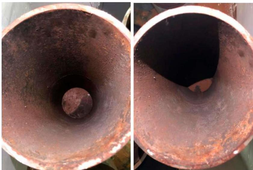
Рисунок 6.14 – Общий вид катушки из стали 13ХФА
