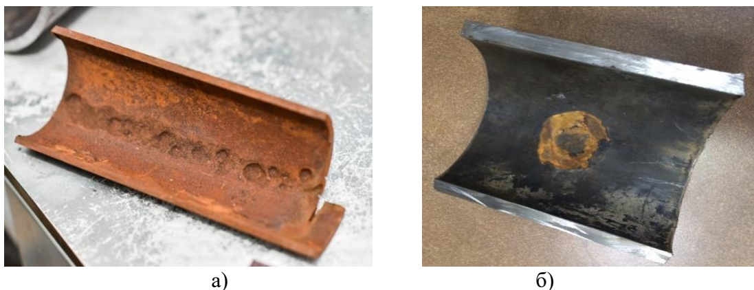
Рисунок 1 – Характер локальной коррозии промышленных труб: а – труба Ø89х6 мм; б – труба Ø114х10мм
