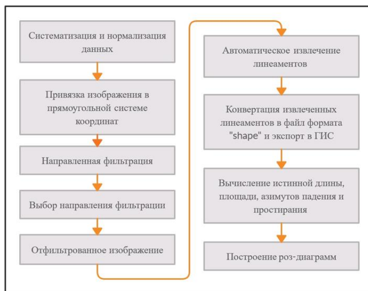
Рисунок 2 – Алгоритм обработки панорамных снимков скважин
