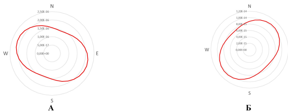
Рисунок 9 – Диаграммы трещинной проницаемости ( k_n , м 2 ) на потенциально водопрводящих интервалах стволов скважин Р-1, интервал 568,0-604,0 (А) м и Р-4, интервал 556,7-557,0 м (Б)
