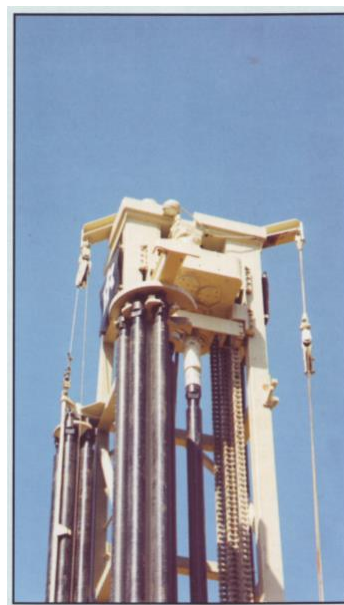
Рисунок 1.8 - Система подачи лебедочного типа с тяговыми роликовыми цепями станка T4W фирмы Ingersoll – Rand США.
