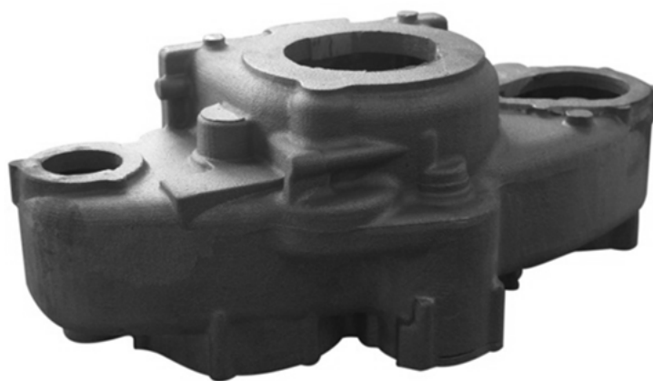
Рис. 31 – Отливка «Корпус коробки приводов» полученная в МИСИС из сплава МЛ10 в форме из ХТС.
