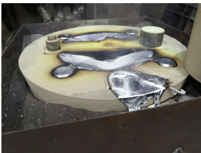
Рис. 75 – Форма, залитая экспериментальным сплавом после его затвердевания.
