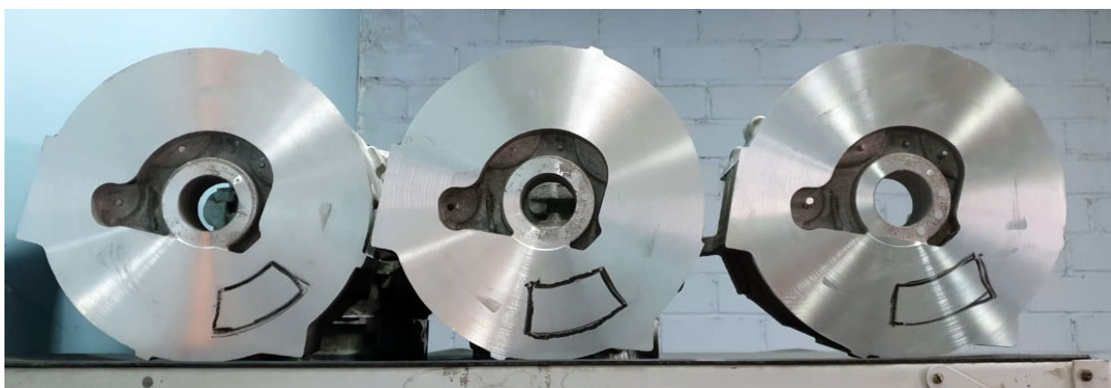
Рис. 54 – Экспериментальные отливки «Корпус» из сплава МЛ10 после испытаний на гидроплотность, отмечены выявленные места течи гидравлической жидкости.
