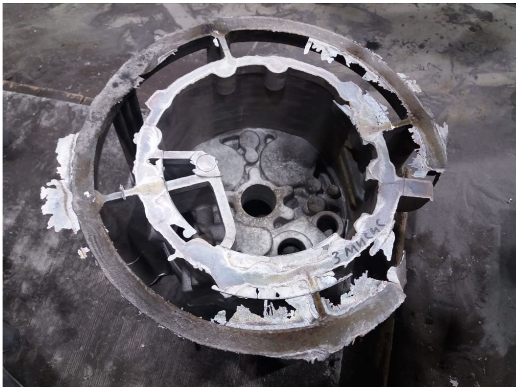
Рис. 76 – отливка после выбивки из формы.
