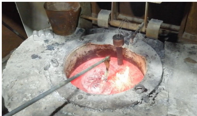
Рис. 70 – Процесс продувки расплава аргоном внутри печи.
