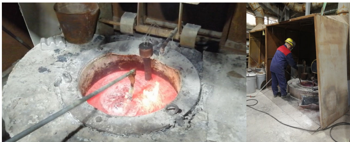
Рис. 164 – Процесс продувки расплава аргоном внутри печи.
