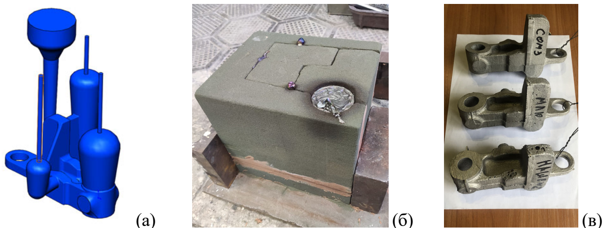
Рис. 138 – Модель тестовой отливки «Кронштейн» с литниково-питающей системой от системы управления самолета ИЛ-76 (а), форма для заливки тестовых отливок (б) и тестовые отливки из сплавов (снизу-вверх) EWZ43, МЛ10 и МЛ-ОПБ.
