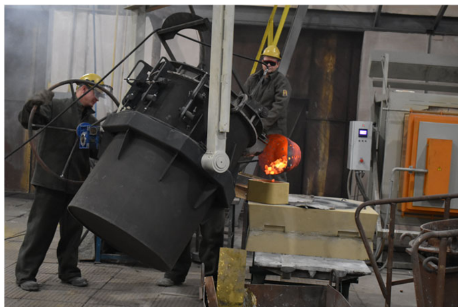
Рис. 160 – Заливка отливки «Крышка промежуточной опоры».
