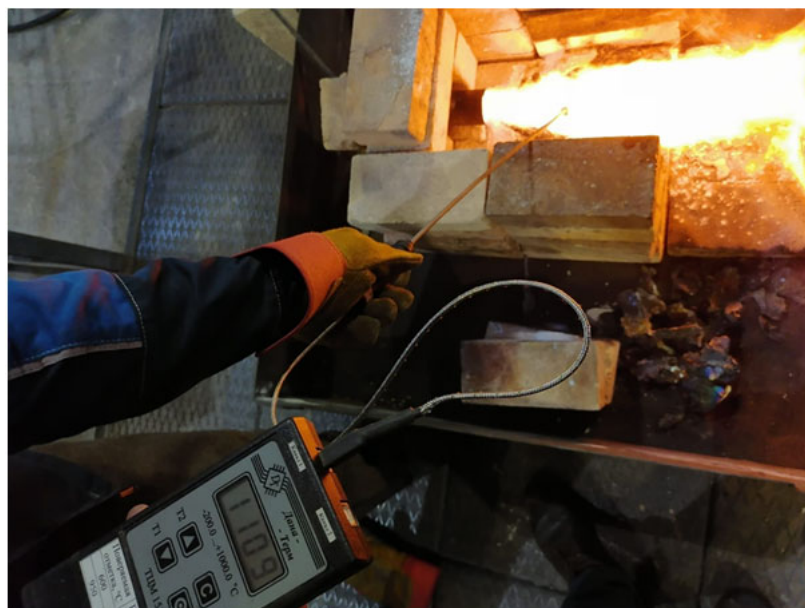
Рис. 139 – Контроль температуры пламени газовой горелки в месте расположения тестовой отливки.
