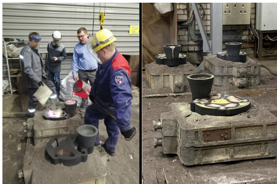
Рис. 169 – Заливка форм, изготовленных по технологии 3d печати.
