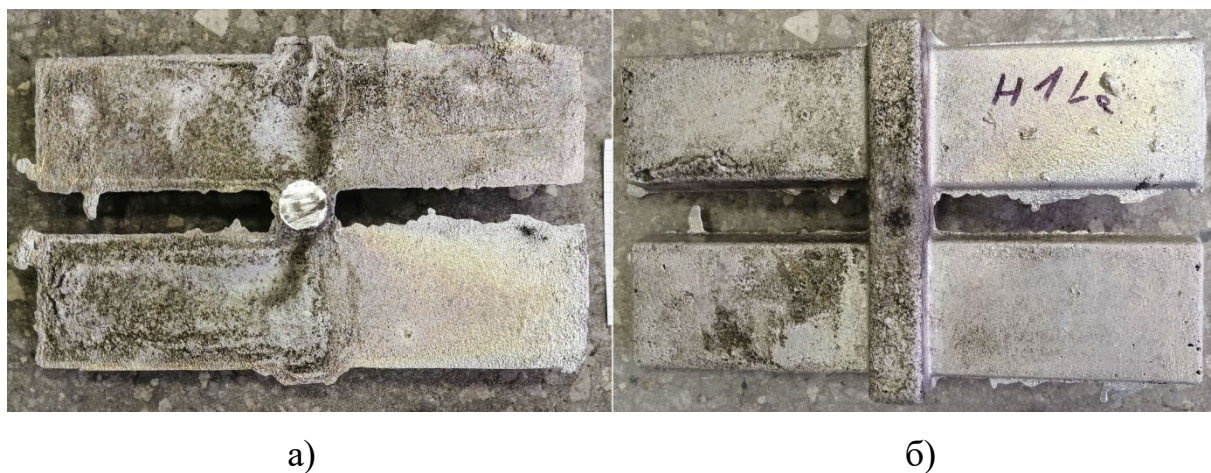
Рис. 61 – Образцы на герметичность из сплавов H1La (вид сверху (а) и снизу(б))
