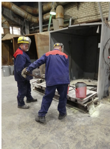
Рис. 166 – Часть металла из носка ковша выплёскивали в изложницу.
