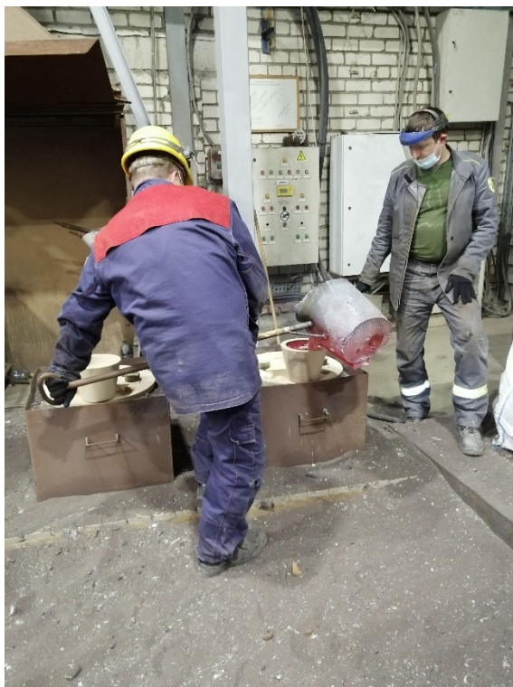
Рис. 74 – Процесс заливки экспериментального сплава в формы.
