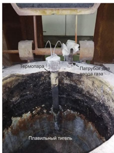
Рис. 64 – Патрубок для ввода защитного газа в пространство тигля.
