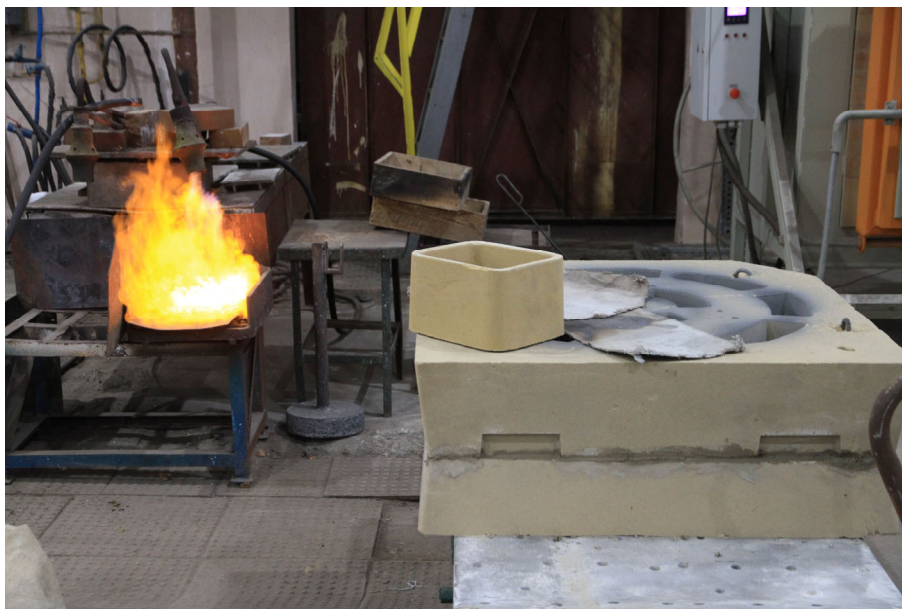
Рис. 162 – Форма, изготовленная по пер-set процессу перед заливкой.
