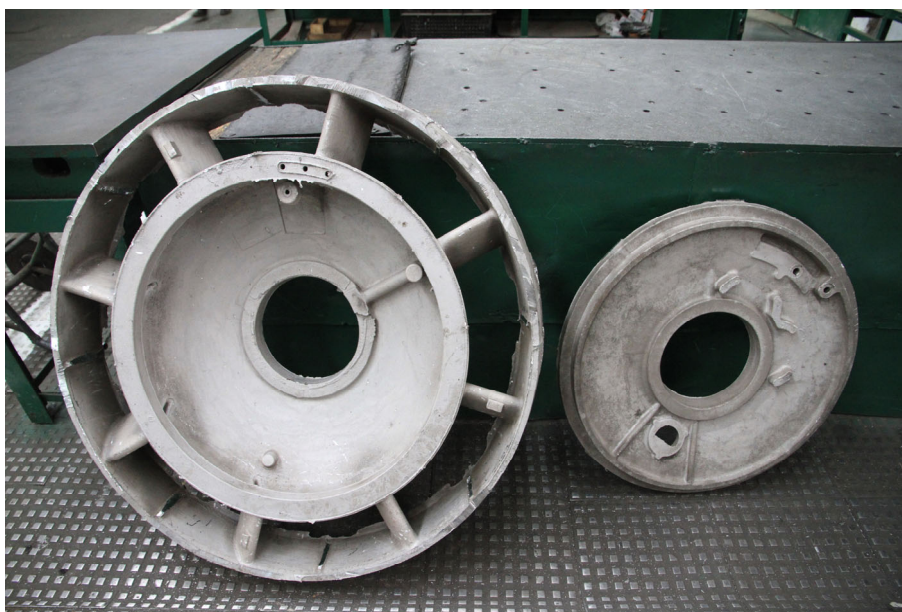
Рис. 163 – Отливки «Корпус промежуточной опоры» «Крышка промежуточной опоры» из сплава МЛ19 после выбивки и обрезки ЛПС.
