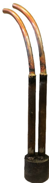
Рис. 81 – Внешний вид стальной крышки тигля с герметично сваренными трубками для подвода и отвода газовой смеси.
