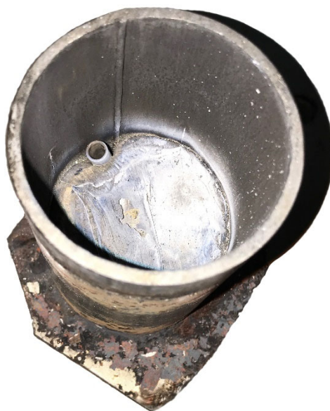
Рис. 84 – Внешний вид слитка в тигле после затвердевания расплава.
