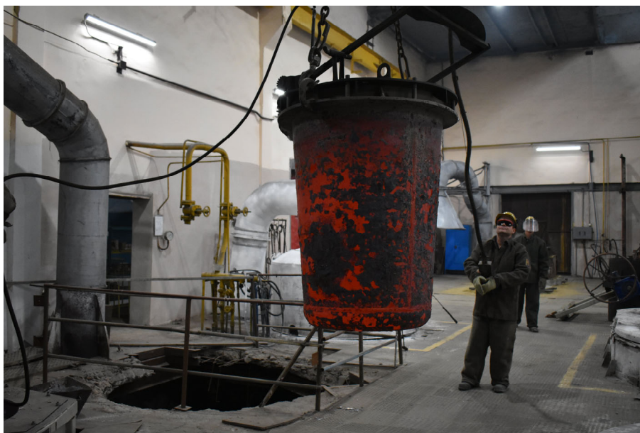
Рис. 158 -Извлечение тигля с расплавом из печи.
