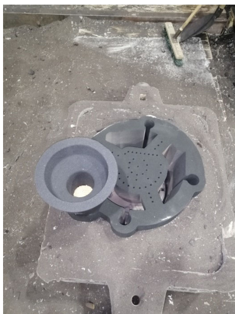
Рис. 168 – Собранный форма в засыпке.
