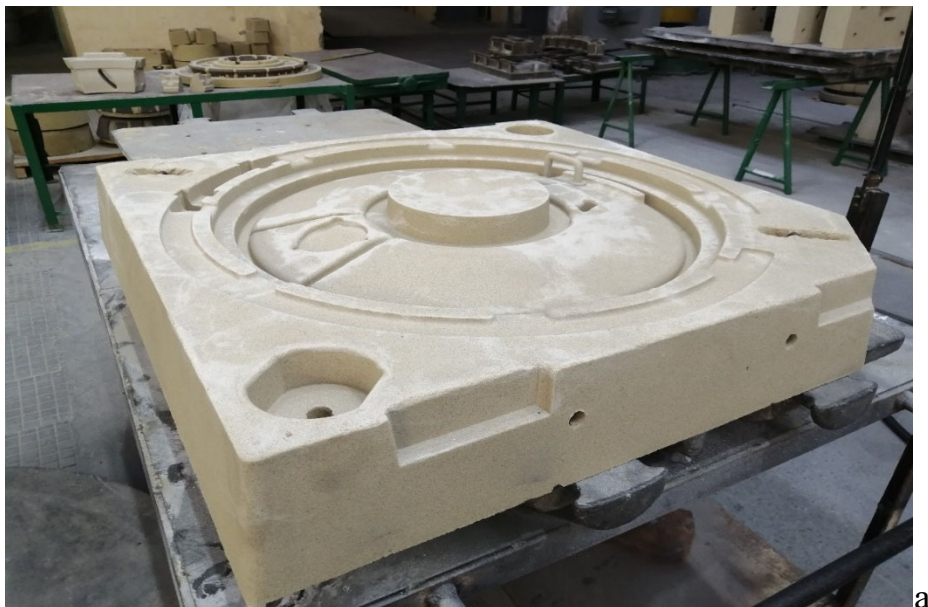
Рис. 161 – Полуформа для получения отливки «Крышка промежуточной опоры», изготовленная по per-set (пеп-сет) процессу.
