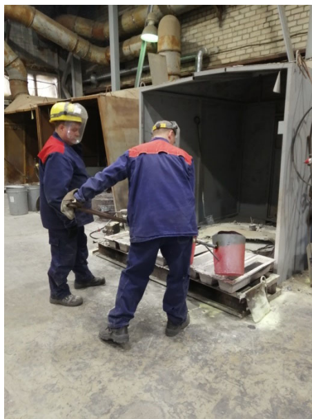
Рис. 73 – Часть металла из носка ковша выплёскивали в изложницу.
