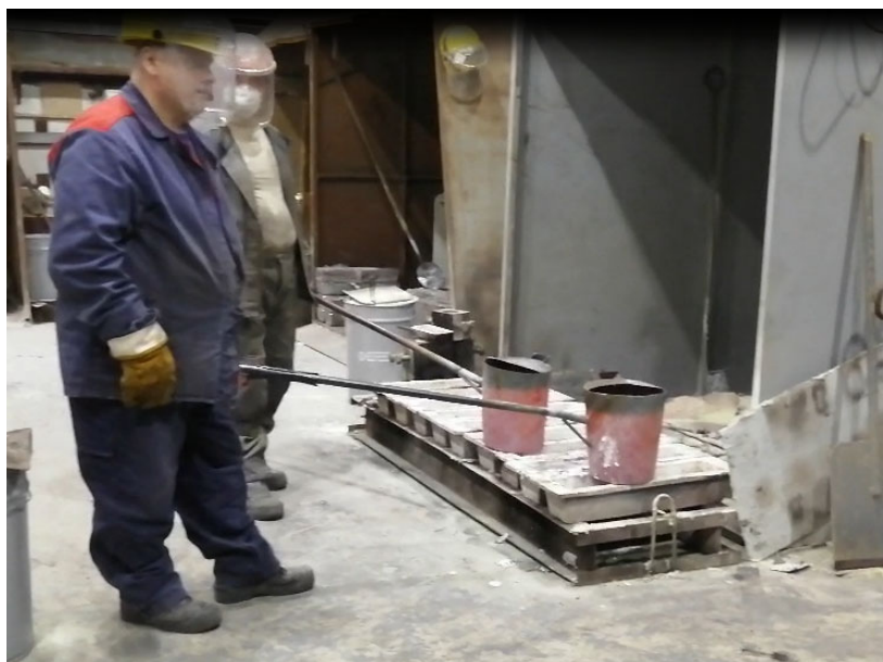
Рис. 72 – Выдержка металла в ручных ковшах перед заливкой в формы.
