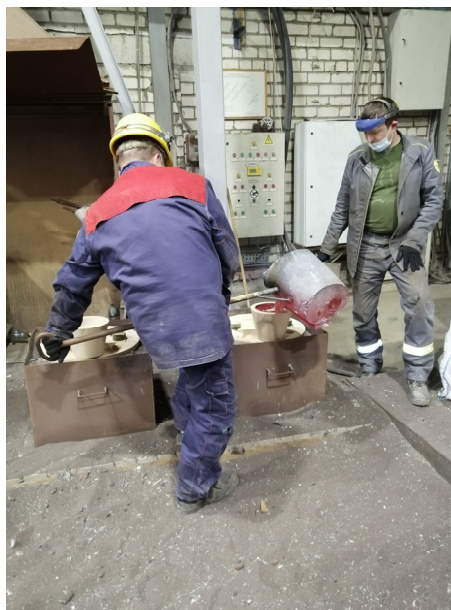
Рис. 171 – Заливка форм, изготовленных по пеп-сет процессу на ПАО АК «Рубин».
