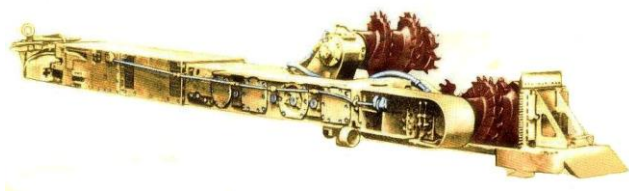
Рисунок 1.11 – Очистной комбайн с несимметрично расположенными двумя шнеками, закрепленными на качающихся рукоятях
