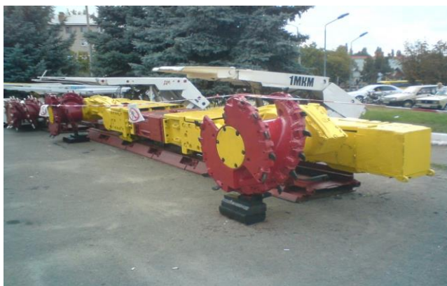
Рисунок 1.15 – Очистной комбайн с двумя симметрично расположенными шнеками
