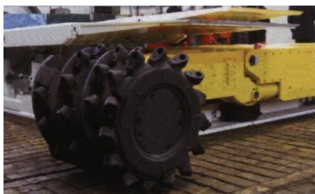
Рисунок 1.3 – Очистной комбайн с одним шнеком на качающейся рукояти
