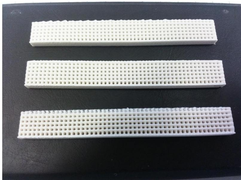
Рисунок 86 – Внешний вид экспериментальных образцов биомиметических каркасов ПЛА/ГАП для испытания на трехточечный изгиб [65]
