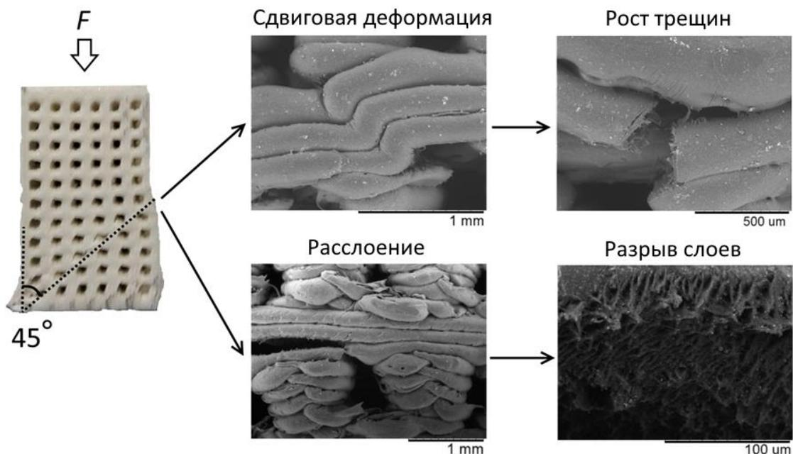
Рисунок 103 – Структура пористого каркаса ПЛА / ГАП после циклической нагрузки (4000 циклов) [63]
