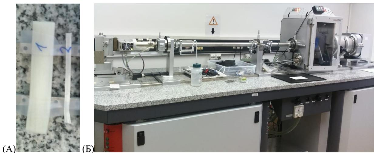
Рисунок 6 – Пример внешнего вида образцов неориентированного (маркировка «1») и ориентированного (маркировка «2») СВМПЭ (А) и общий вид установки Bruker NANOSTAR (Б)
