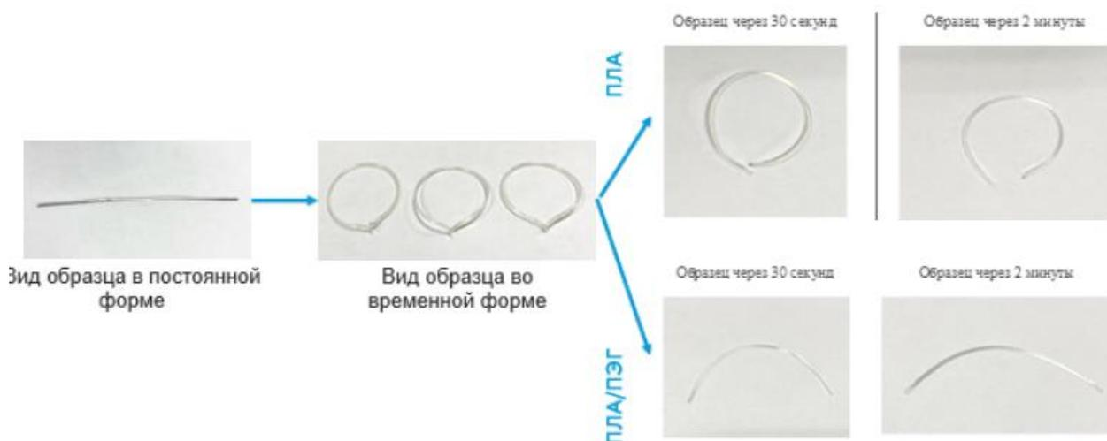
Рисунок 62 – Пример снижения температуры активации ЭПФ в ПЛА за счет снижения температуры начала стеклования после пластификации ПКЛ
