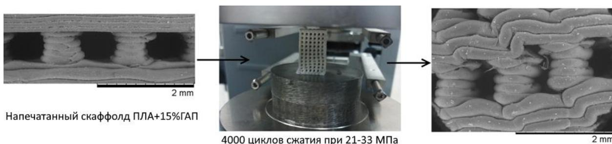
Рисунок 96 – Микроструктура пористого каркаса на основе ПЛА до и после циклической нагрузки [63]
