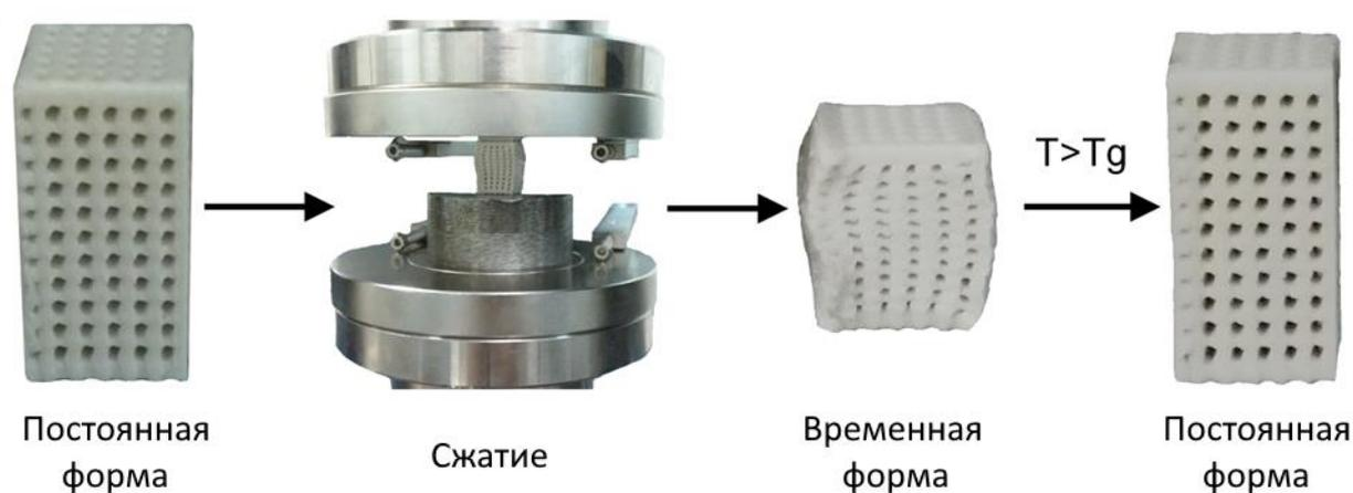
Рисунок 39 – Пример демонстрации цикла ЭПФ: программирование временной формы путем сжатия и активация ЭПФ [42]
