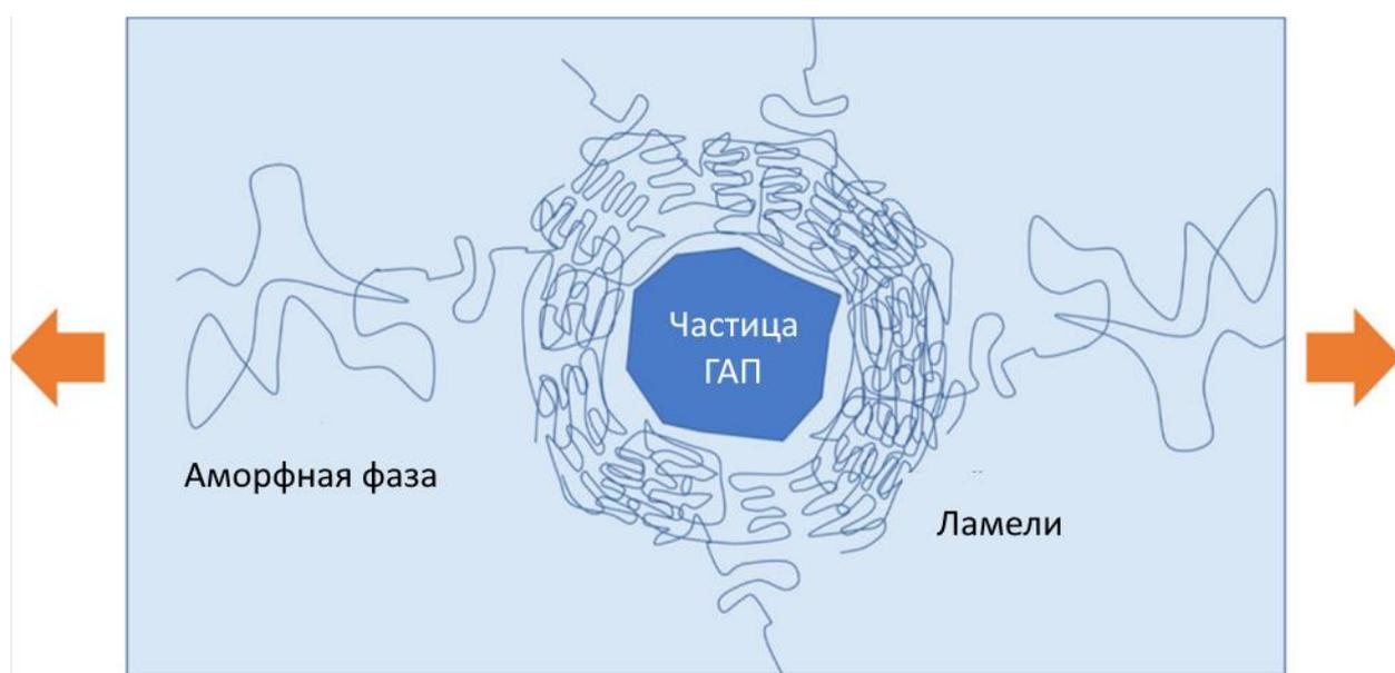
Рисунок 38 – Иллюстрация механизма деформации композита ПЛА/ГАП. Система состоит из наполнителя ГАП, ламеллярной структуры ПЛА и аморфной матрицы ПЛА
