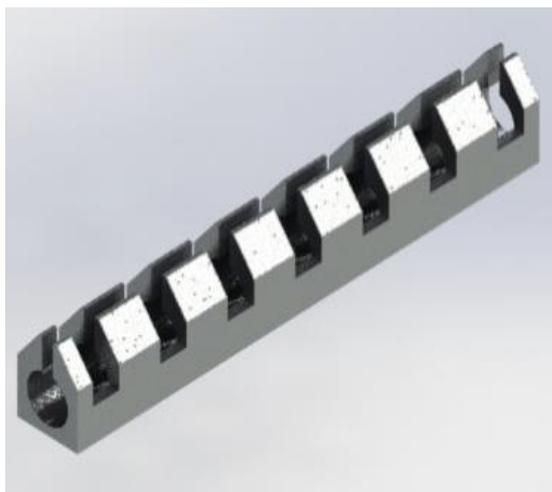
Рисунок 53 – Держатель для волокон СВМПЭ, разработанный и изготовленный методом 3Д-печати из алюминиевого сплава совместно с К.Няза, для проведения серии экспериментов по оценке кажущейся энергии активации полимера с ЭПФ  $T_m$ -типа [48]
