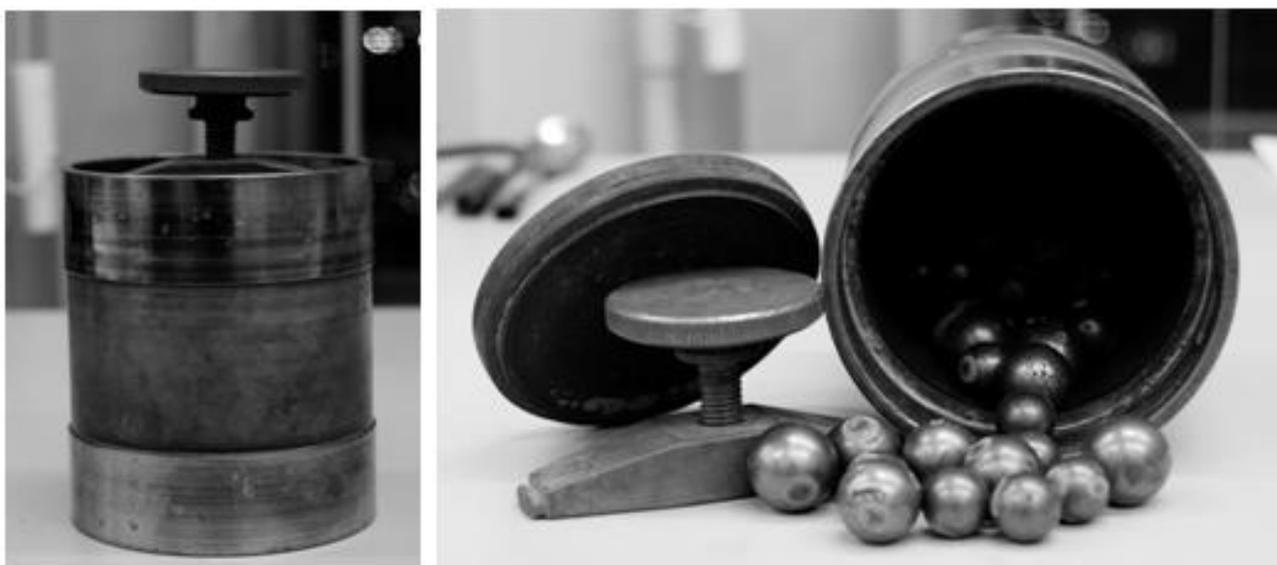
**Рисунок 3.1** – Лабораторная шаровая мельница
