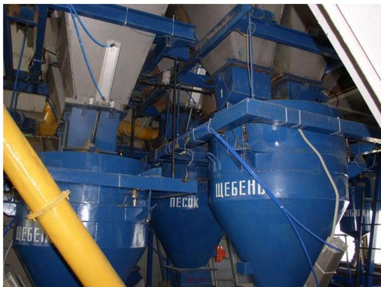
**Рисунок 3.** Общий вид дозаторов типа ДЗ и ДХ.
