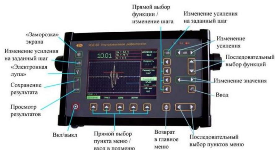
Рисунок 1 – Внешний вид дефектоскопа УСД-60Н
