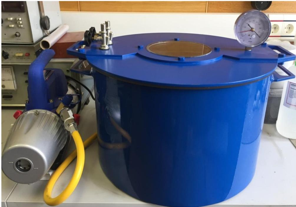
Рисунок 2.7 – Вакуумная система дегазации МТ 3D
