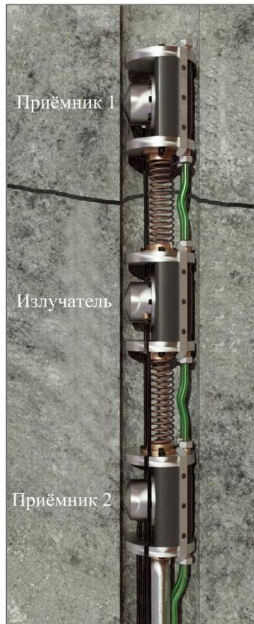
Рисунок 4.15 – Схема расположения каротажного зонда в скважине
