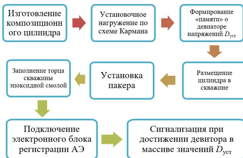
Рисунок 2.59 – Алгоритм проведения измерений
