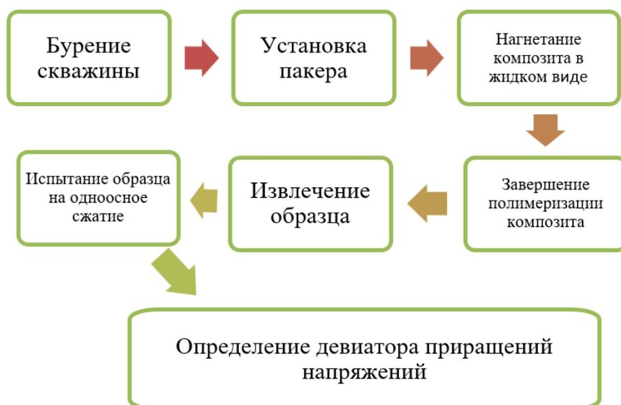
Рисунок 2.61 – Последовательность действий при реализации способа определения приращений девиатора напряжений в массиве
