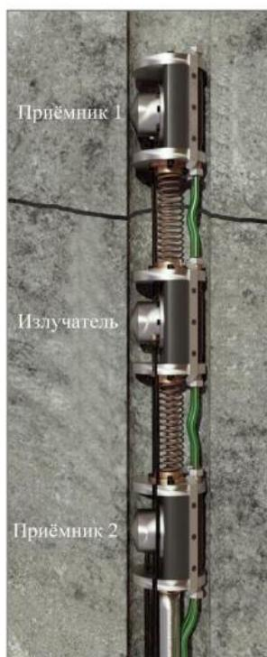
Рисунок 4 – Схема расположения каротажного зонда в скважине
