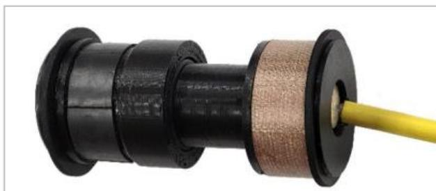
Рисунок 7 – Система клеевой фиксации, подготовленная к размещению в скважине
