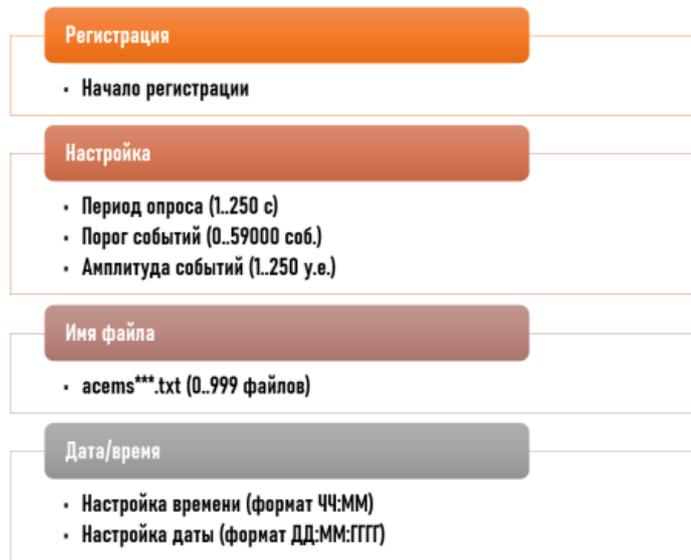
Рисунок 5 - Блок-схема меню электронного блока регистрации АЭ
