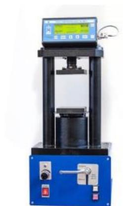
Рисунок 8 – Внешний вид испытательного прессы ПГМ-100МГ4
