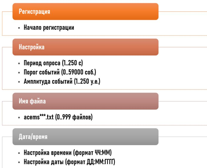
Рисунок 2.57 - Блок-схема меню электронного блока регистрации АЭ
