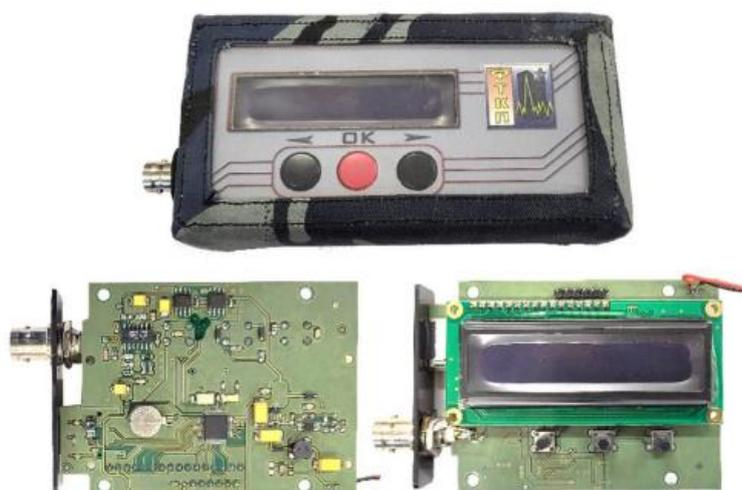
Рисунок 4 – Внешний вид и внутреннее устройство электронного блока регистрации АЭ
