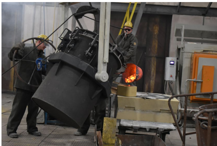
Рис. 26 – Заливка отливки «Крышка промежуточной опоры»
