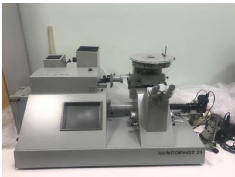
Рисунок 2.23 – Оптический металлографический микроскоп Neophot–21 фирма Carl Zeiss Jena, Германия
