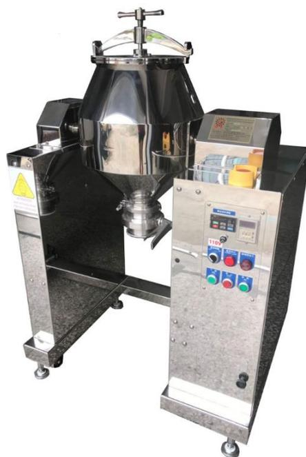
Рисунок 2.15– Двухконусный смеситель RT-NM05S
