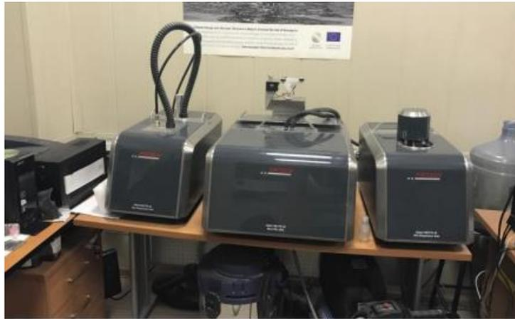
Рисунок 2.21– Лазерный анализатор частиц Fritsch Analysette 22
