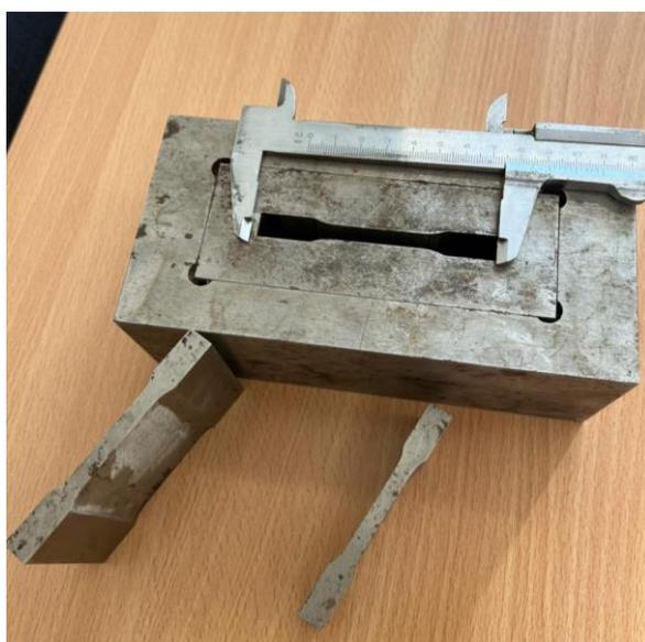
Рисунок 2.18– Лабораторная пресс-форма изготовления образцов для испытания на растяжение по ГОСТ 18227-98 для холоднопрессованных и спеченных образцов
