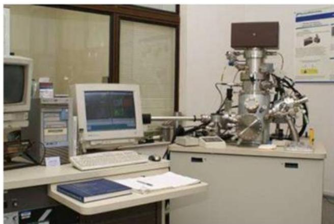
Рисунок 2.25 – Оже-электронный спектрометр РНІ-680
