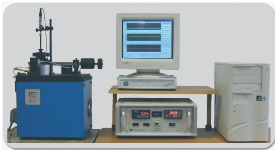
Рисунок 2.26 – Трибометр Т-11
