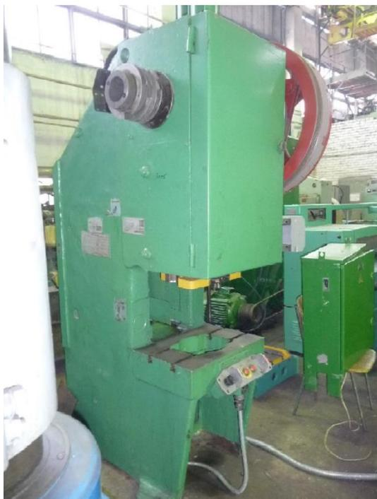
Рисунок 2.20 – Пресс кривошипный модели K2232
