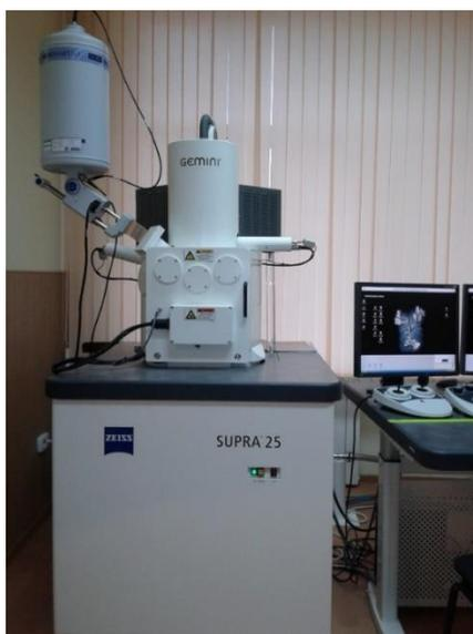
Рисунок 2.24 – Растровый электронный микроскоп модели ZEISS SUPRA 25
