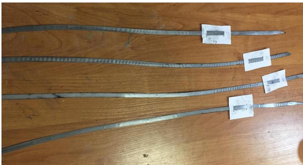
Рисунок 4.3 – Образцы полос композиционного материала, состава № 1, 2, после прокатки
