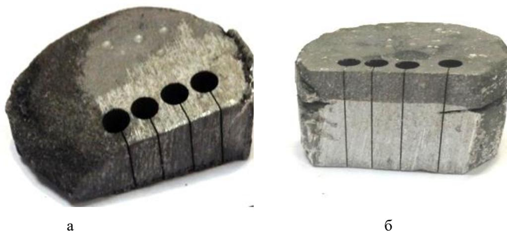
а – Пропитанная заготовка состава, об. %: 57,2 Al - 25,9 В<sub>4</sub>С - 16,9 W
