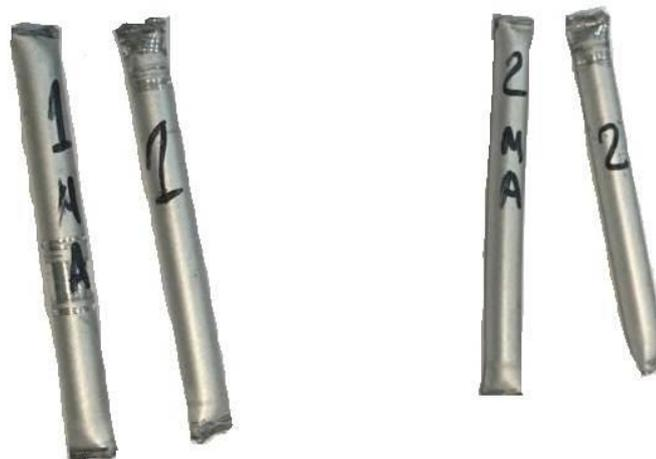
Рисунок 4.2 – Заготовки для холодной прокатки, заполненные армирующей смесью
