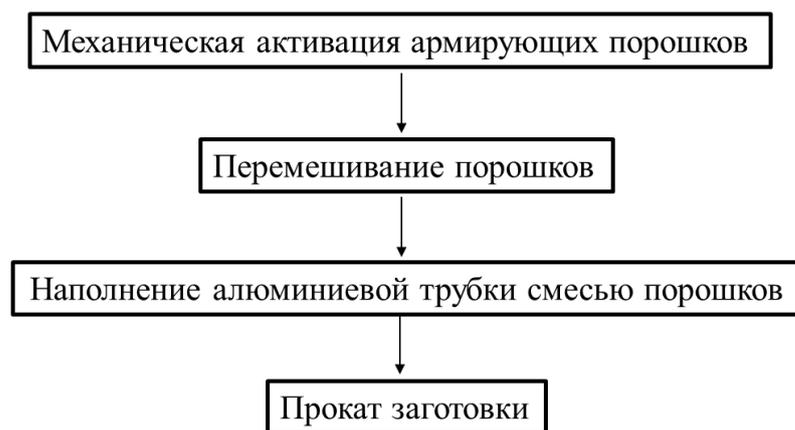
Рисунок 4.1 – Схема получения композиционного материала методом холодной прокатки
