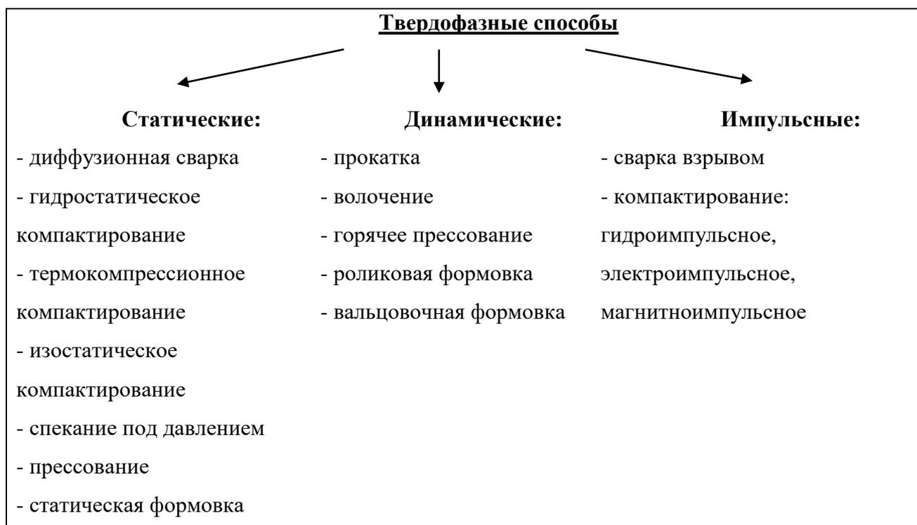
Рисунок 1.1 – Твердофазные способы получения металломатричных композиционных материалов
