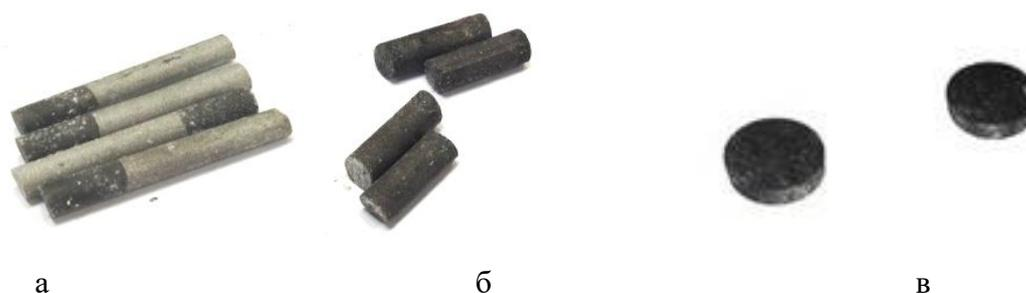
а,б – для исследования механических характеристик;
