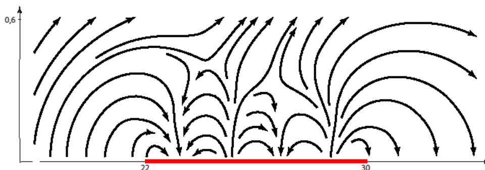
Рисунок 20 – Крупный план силовых линий магнитного поля на пятом резонансе. Направления силовых линий показаны в плоскости, перпендикулярной резонатору, по горизонтальной оси отложено расстояние до центра спирали в миллиметрах, здесь внутренний радиус спирали равен 22 мм, а внешний радиус спирали равен 30 мм. На вертикальной оси отложено расстояние до плоскости спирали в миллиметрах. Красной линией показана область спирали в поперечном сечении.
