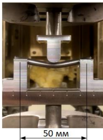
Рисунок 15 – Фотография системы в процессе испытаний на трёхточечный изгиб
