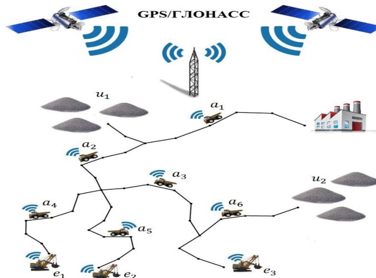
Рис. 1.1 Упрощенная схема транспортно-технологических процессов в карьере
