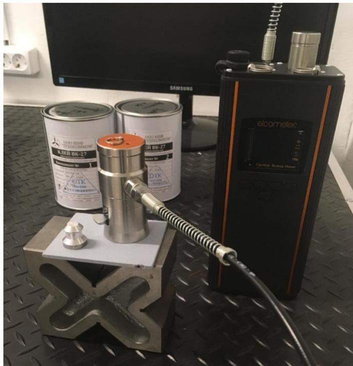
Рисунок 18 – Автоматический адгезиметр Elcometer 510; клей ВК-27
