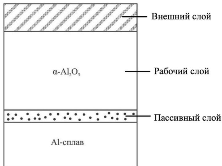
Рисунок 8 – Типичное строение ПЭ покрытий на деформируемом алюминиевом сплаве
