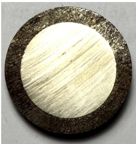
Рисунок 19 – Образец, полученный из микрогранул, с содержанием азота в плазмообразующем газе 0,15 атм.
