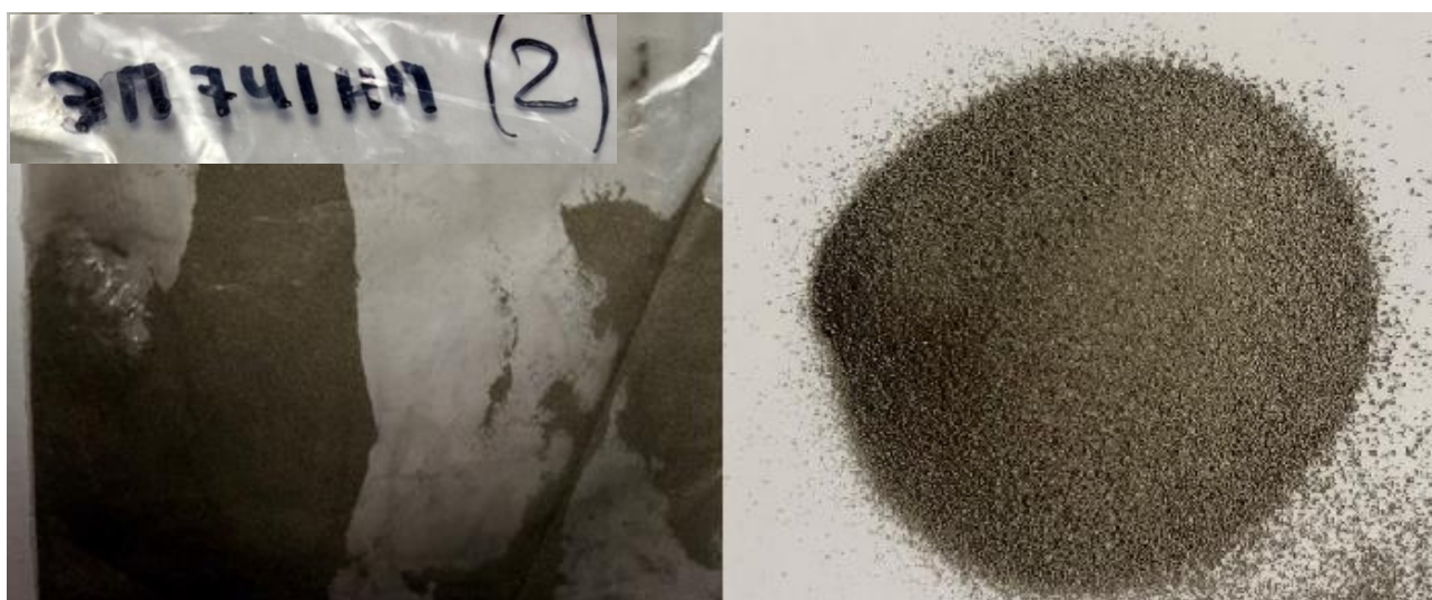
Рисунок 18 – Внешний вид, полученных микрогранул, с содержанием азота 0,026 %, состав плазмообразующего газа (б)
