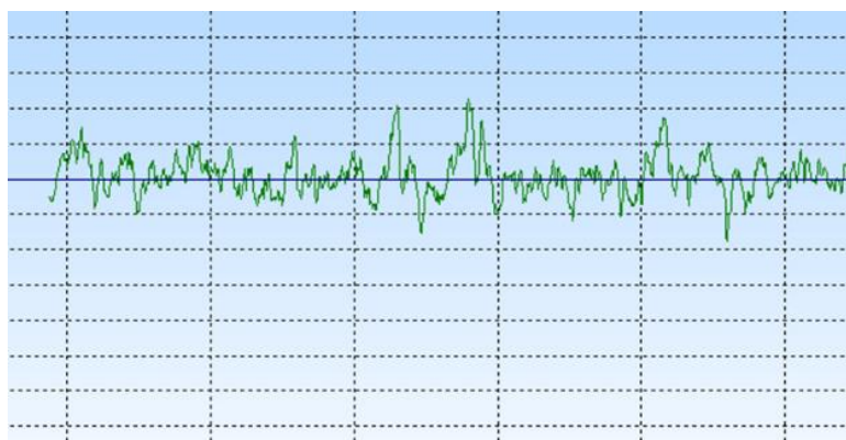
Рисунок 4.9 – Шероховатость покрытий на основе порошковой композиции Cu-Al 2 O 3 : a – Ra = 3,6 мкм; б - Ra = 4,6 мкм
