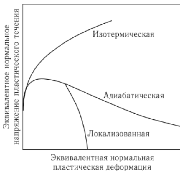
Рисунок 4.4 – Кривые напряжение-деформация при различных процессах деформации твердых тел [94]
