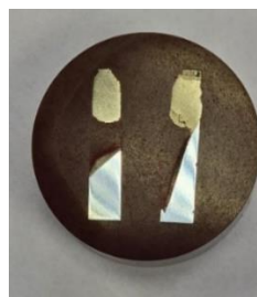
Рисунок 3.11 – Результаты испытаний стальных образцов, частично покрытых алюмоцинковым покрытием: а – коррозия покрытия в верхней части образца с приростом материала; поверхность стали без следов коррозии; б – шлифы для оценки микротвердости продуктов коррозии по Виккерсу.
