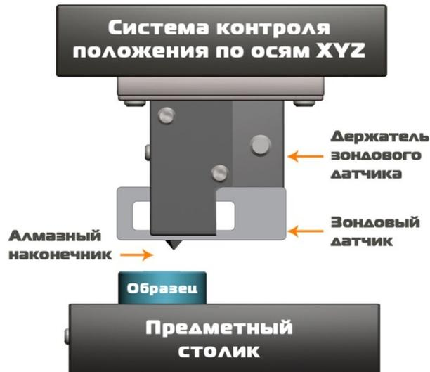
Рисунок 2.18 — Схема измерительного блока сканирующего твердомера «НаноСкан-3D»
