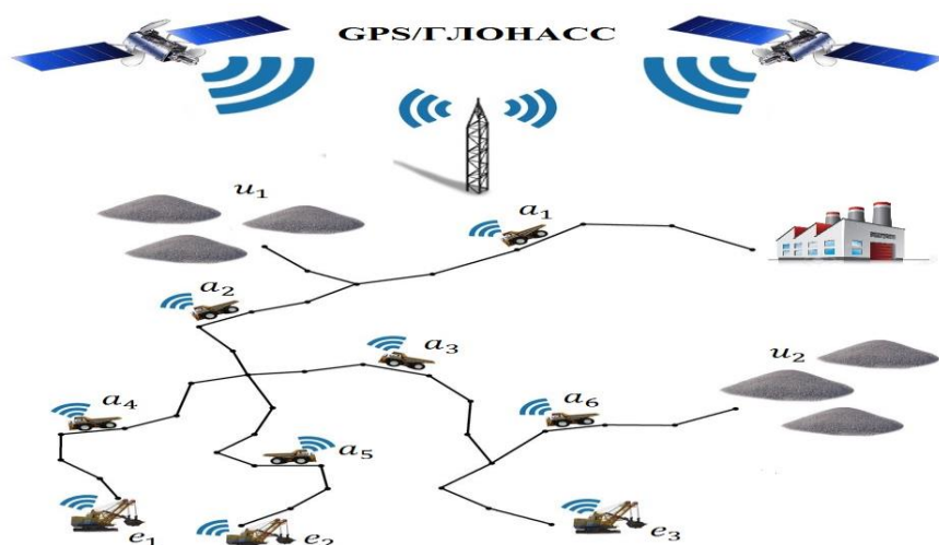
Рис.1 Упрощенная схема транспортно-технологических процессов в карьере
