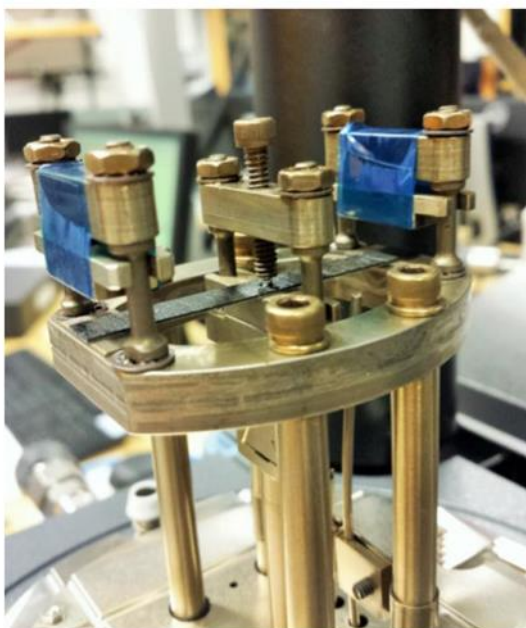
Рисунок 6 – Полимерный образец в форме балки, установленный в устройство динамомеханического анализа (ДМА), с целью проведения испытаний на трехточечный изгиб
