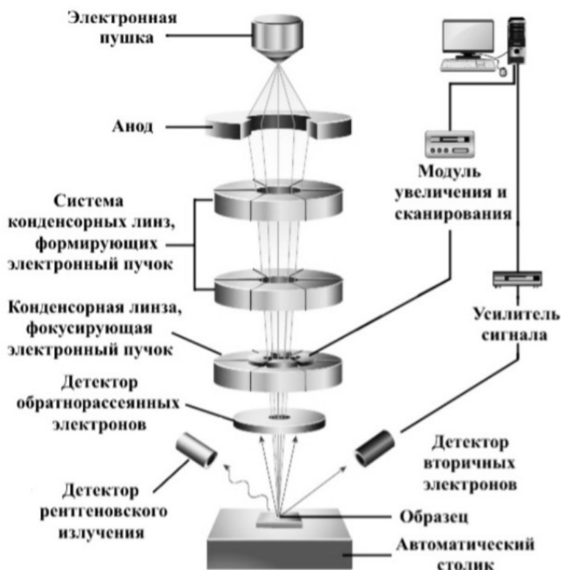
Рисунок 5 – Схема устройства сканирующего электронного микроскопа [131]
