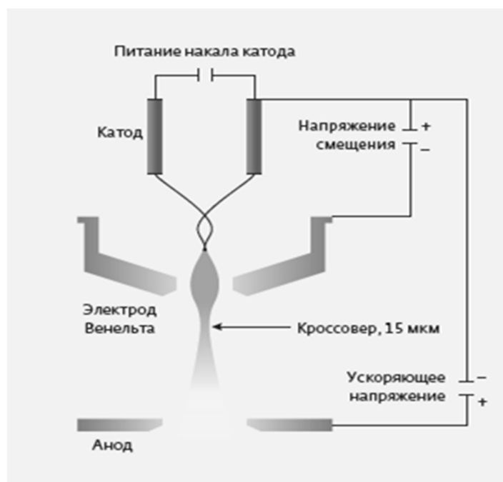
Рисунок 6 – Устройство электронной пушки термоэмиссионного типа
