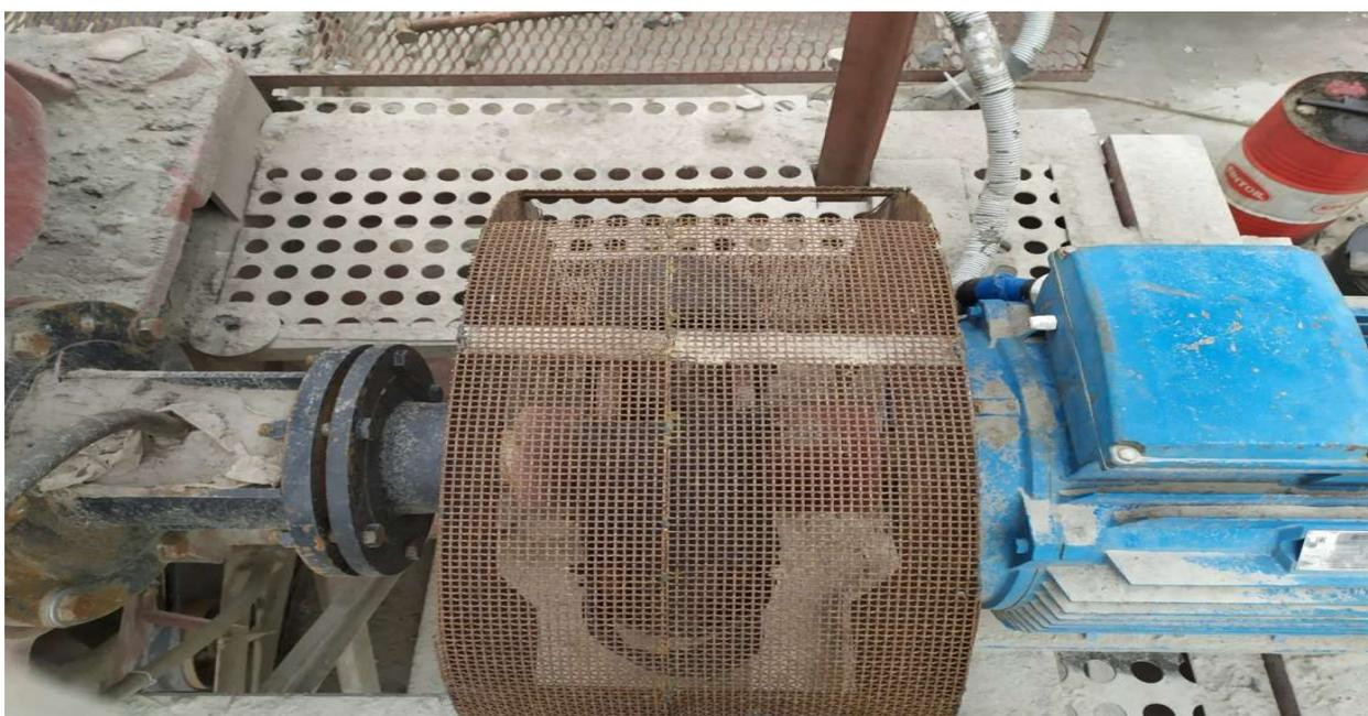
Рисунок 3.3 – Привод дробилки конусной.
