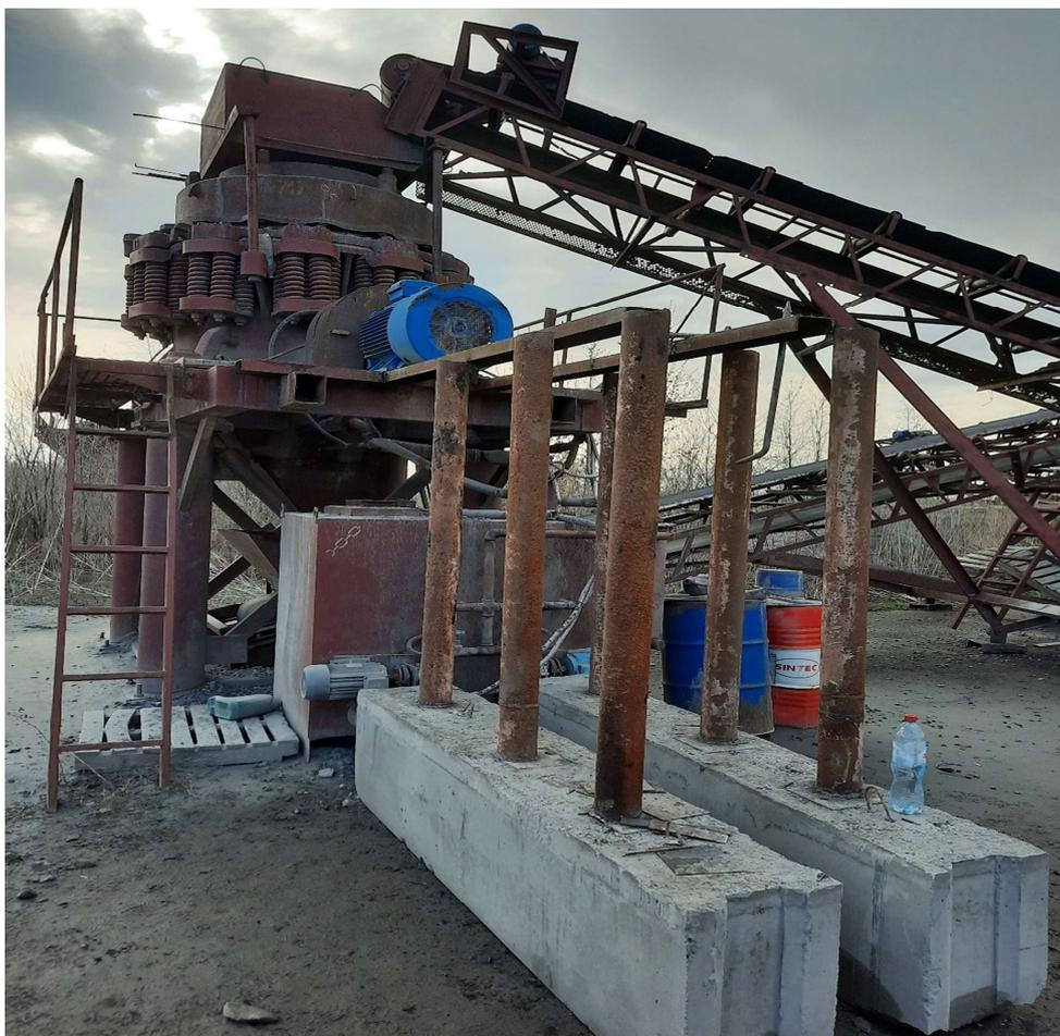
Рисунок 3.8 – Фундамент и дополнительная рама
