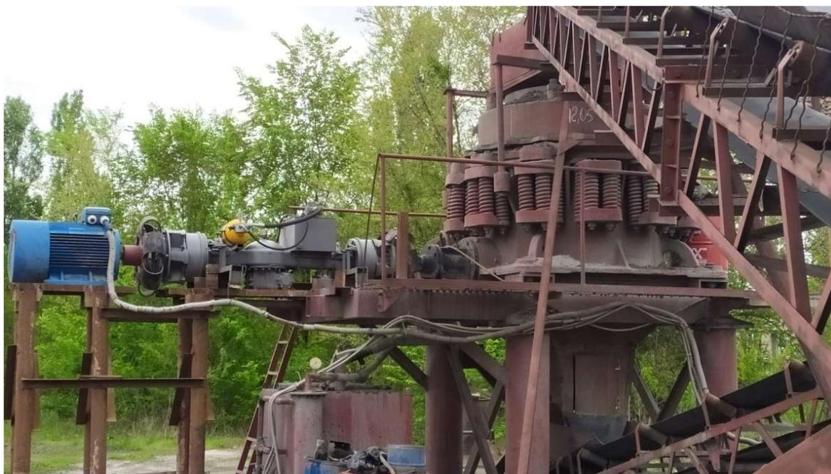
Рисунок 3.9 – Установка опытного образца в привод дробилки
