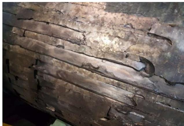
Рисунок 1.7 – Разрушенный слой эксцентрика.
