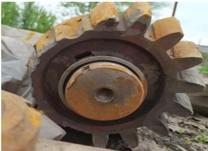
Рисунок 1.8 – Излом зубьев шестерни.
