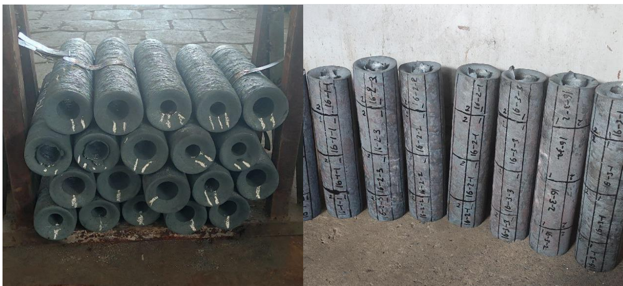
Рисунок 2 - Внешний вид заготовок после прошивки.
