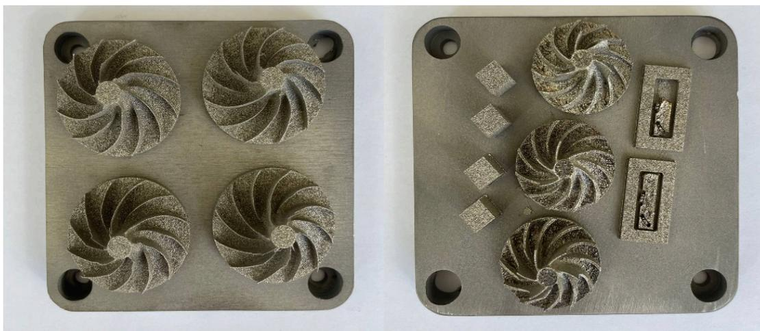
Рисунок 11 – Модельные образцы, полученные по технологии СЛС из сфероидизированного порошка сплава TNM-B1+Y<sub>2</sub>O<sub>3</sub>
