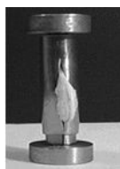
Рисунок 3 - Вид образца с трещиной после испытаний
