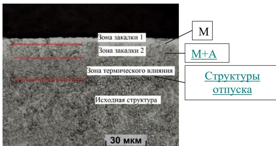
Рисунок 3.4.1 – Фотография торцевого среза стали, обработанной ИПП в диапазоне №3
