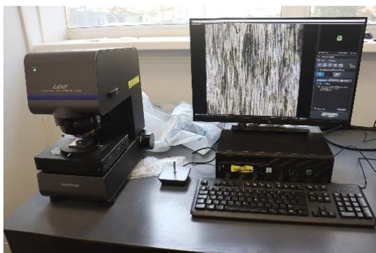
Рисунок 2.3.1 – Конфокальный микроскоп LEXT OLS5000
