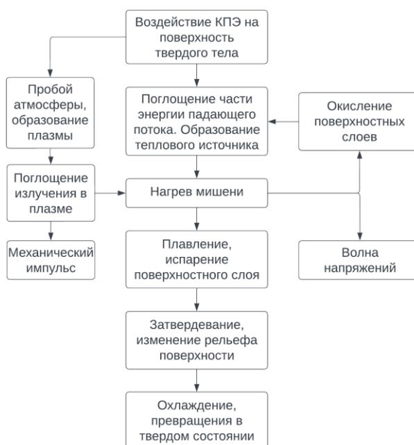
Рисунок 1.3.1 – Основные процессы, происходящие при воздействии КПЭ на поверхность металлических материалов [14]
