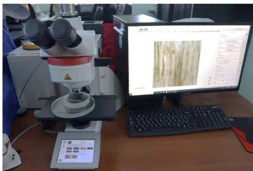
Рисунок 2.3.9 – Внешний вид оптического микроскопа Leica DM 6M
