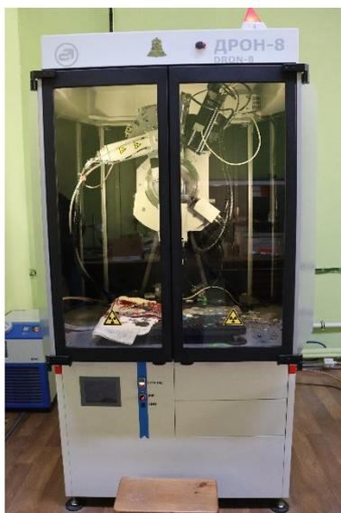
Рисунок 2.3.6 – Рентгеновский дифрактометр ДРОН-8
