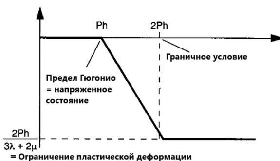
Рисунок 1.3.5 – Зависимость поверхностной пластической деформации от давления, вызванного лазерным воздействием [81]
