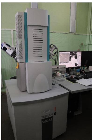
Рисунок 2.3.5 – Сканирующий электронный микроскоп Tescan Vega 3
