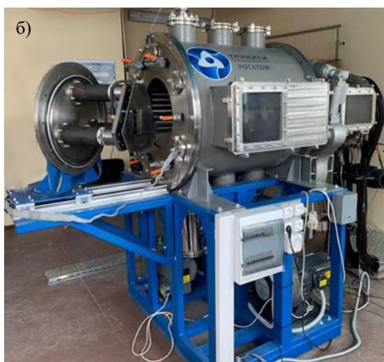
Рисунок 2.2.3 – Макет (а) и фотография (б) внешнего вида ключевых компонент разработанной установки для обработки изделий ИПП
