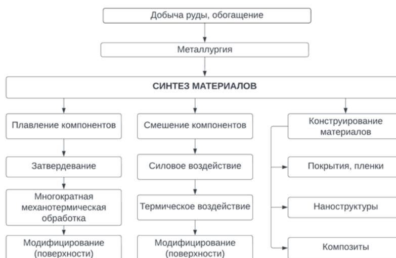
Рисунок 1.2.1 – Схема создания материалов и возможные пути синтеза [14]
