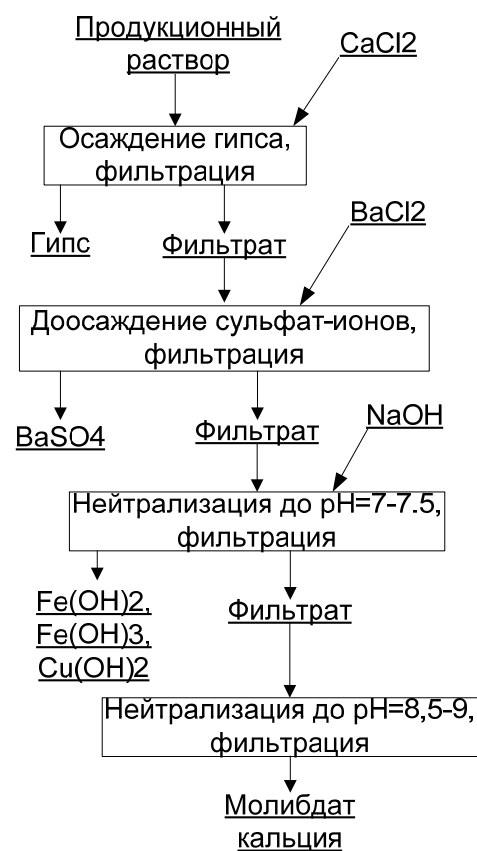
Рисунок 15 – Схема осаждения молибдата кальция
