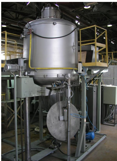
Рисунок 10 – Опытно-промышленная установка ВД-300-16 для получения кальция высокотемпературным алюминотермическим способом из оксида.
