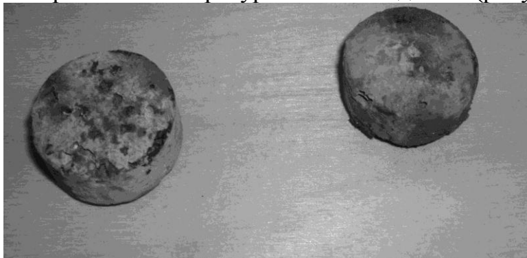
Рисунок 5 – Вид брикетов после восстановления при температуре 1525 \pm 25^\circ\text{C} в течение 10 часов.
