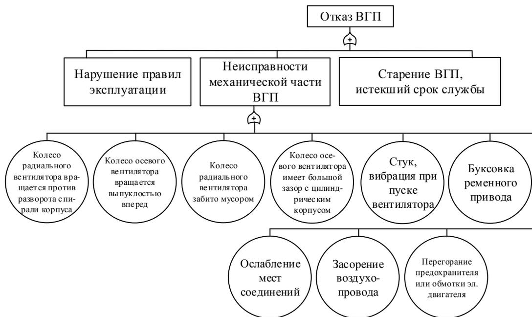
Рисунок 3.5 – Причинно-следственные связи между нежелательными событиями, приводящими к отказу вентилятора главного проветривания
