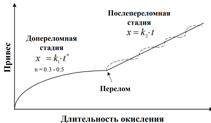
Рисунок 1.1 – Стадии окисления циркониевых материалов в воде и перегретом паре
