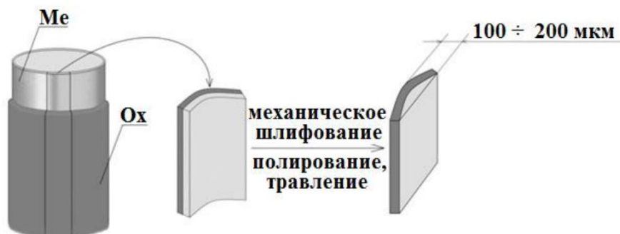
Рисунок 2.14 – Вырезание, механическое шлифование, полирование и травление сегментов труб до появления гладкой поверхности металла на внутренней поверхности образца
