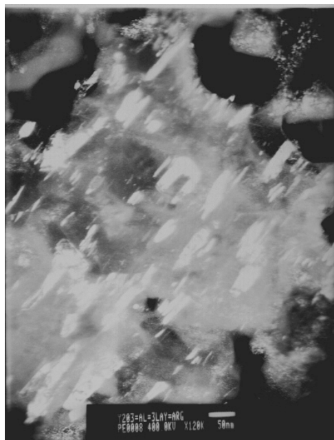
Рисунок 12 – Структура кристаллизованной пленки оксида иттрия в темном поле трансмиссионного электронного микроскопа
