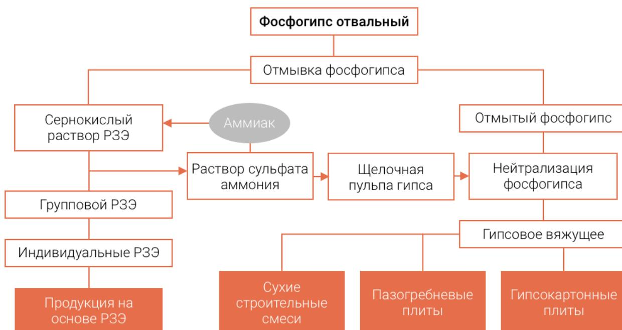
Рисунок 15 - Схема комплексной переработки фосфогипса с извлечением РЗЭ
