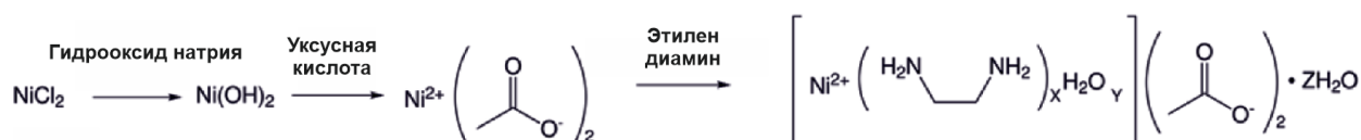
Рисунок 12 – Схема синтеза прекурсора ТЭД-НА для тонких пленок NiO
