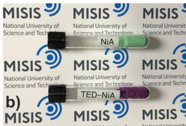
Рисунок 13 - Фотография ацетата никеля (NiA) и синтезированного прекурсора трис (этилендиамин) ацетата никеля (ТЭД-НА) [104]
