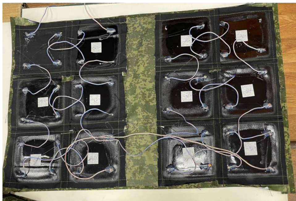
Рисунок 136 – Спайка ПФМ в пенале
