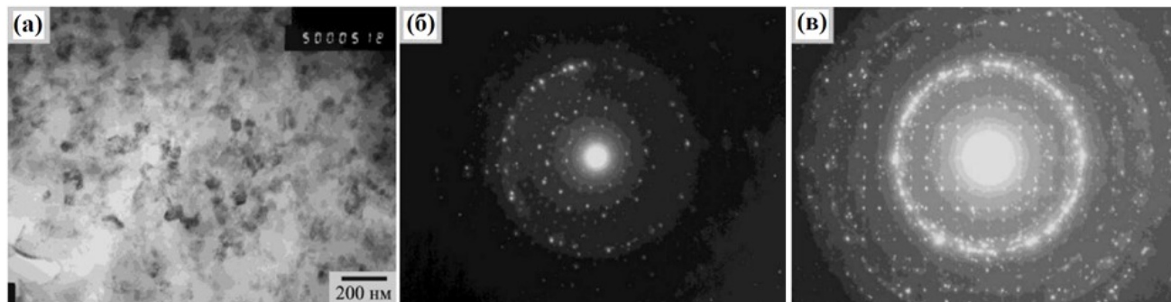
Рисунок 15. Светлопольное изображение (просвечивающий электронный микроскоп) (а) и картины дифракции электронов вдоль осей 10-го (б) и 2-го (в) порядков для сплава \text{Al}_{73}\text{Cu}_{11}\text{Cr}_{16} , приготовленного путем механосплавления в течение 14 часов с последующим отжигом при 700 °С в течение 1 часа
