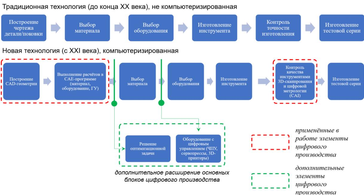
Рисунок 2.2. Сравнение схем разработки технологических процессов
