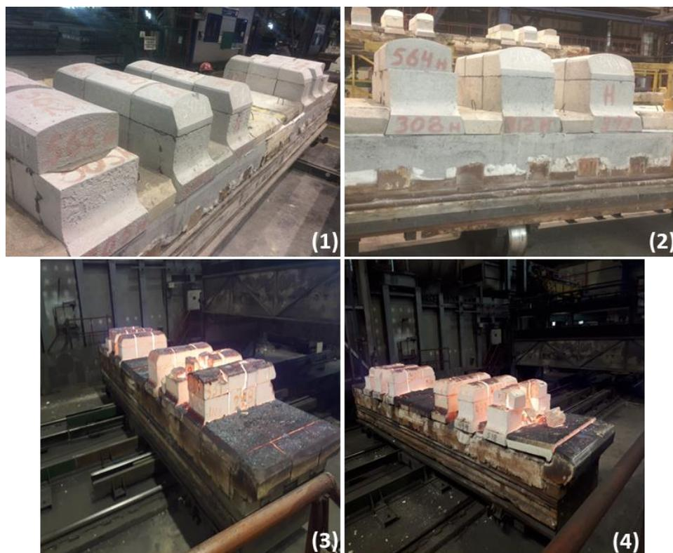
1, 2 – нагревательная телега ЛПЦ с установленными огнеупорными блоками;
