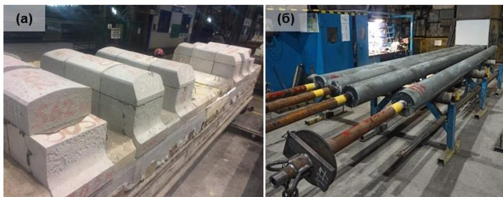
а – огнеупорные блоки телег ЛПЦ, б – фурмы продувки УПК
