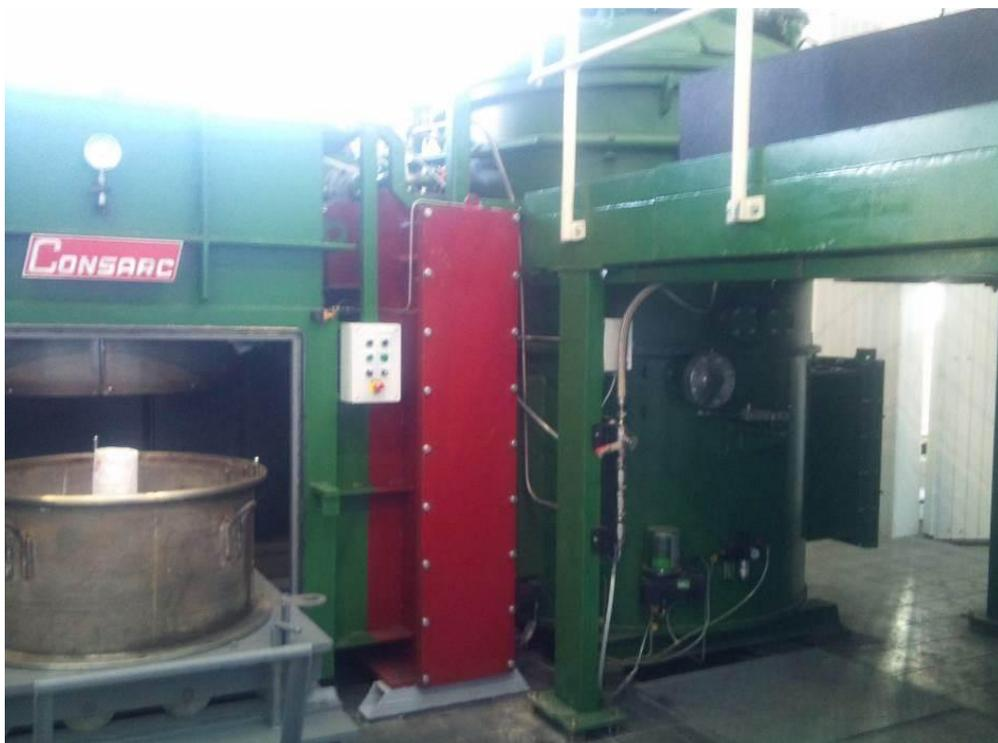
Рисунок 8 – Вакуумная плавильно-заливочная установка с медным водоохлаждаемым тиглем Consarc, используемая для отливок турбинных лопаток
