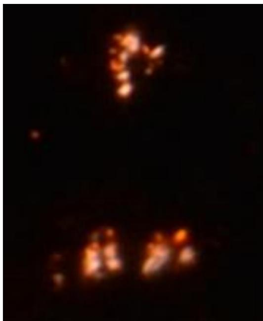
Рисунок 38 – Типичное распределение микрозарядов при проведении МДО сплавов на основе  $\gamma$ -TiAl, когда на поверхности рабочего электрода реализуются как анодные, так и катодные микрозаряды
