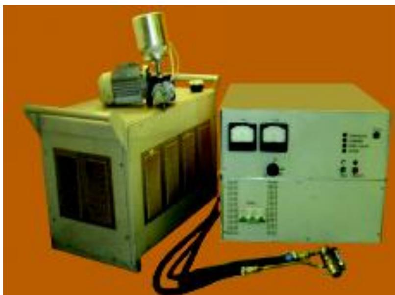
Рисунок 9 – Внешний вид установки для плазменного напыления с инверторным источником тока: максимальная мощность 40 кВт; максимальный ток нагрузки 150 А
