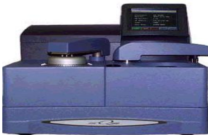
Рисунок 3.4 – Установка ДСК Q20 TA инструменты
