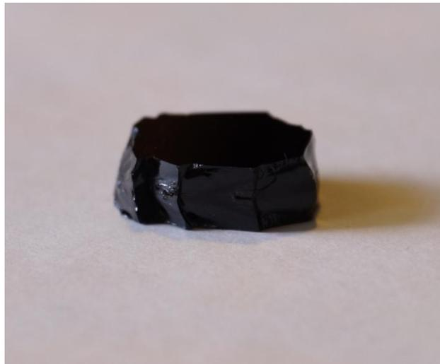
Рисунок Б5 - Образец шлакового расплава состава, % масс.: 46,6 – SiO<sub>2</sub>, 21,5 – CaO, 3,2 – MgO, 2,8 Al<sub>2</sub>O<sub>3</sub>, 20 Fe<sub>2</sub>O<sub>3</sub>, 2,29 P<sub>2</sub>O<sub>5</sub> после расплавления при T=1500 °С, выдержке в течение 30 мин, основность B=0,5
