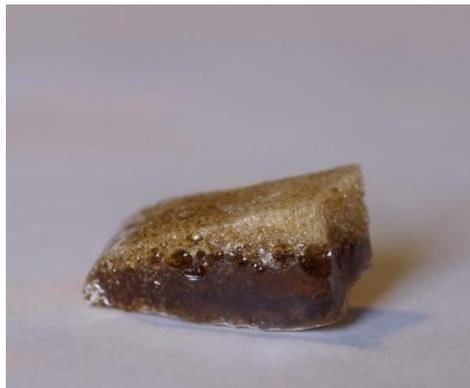
Рисунок Б2 - Образец шлакового расплава состава, % масс.: 58,6 – SiO<sub>2</sub>, 27,1 – CaO, 4,0 – MgO, 3,6 Al<sub>2</sub>O<sub>3</sub>, 2,29 P<sub>2</sub>O<sub>5</sub> после расплавления при T=1500 °C, продувке N<sub>2</sub> в течение 20 мин, основность B=0,5
