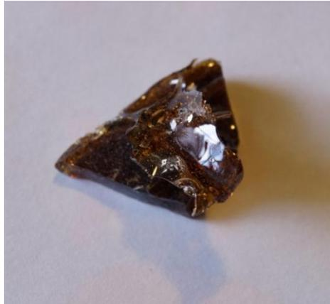
Рисунок Б1 - Образец шлакового расплава состава, % масс.: 50 – SiO<sub>2</sub>, 33 – CaO, 4,9 – MgO, 4,4 Al<sub>2</sub>O<sub>3</sub>, 2,29 P<sub>2</sub>O<sub>5</sub> после расплавления при T=1500 °C, продувке Ar в течение 20 мин, основность B=0,7
