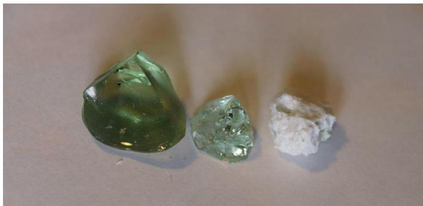
Рисунок Б3 - Образцы шлакового расплава после расплавления при T=1500 °C и выдержке в течение 40 мин состава, % масс.: а) 51,4 – SiO<sub>2</sub>, 32,0 – CaO, 4,7 – MgO, 4,2 Al<sub>2</sub>O<sub>3</sub>, 2,29 P<sub>2</sub>O<sub>5</sub>; б) 60,1 – SiO<sub>2</sub>, 26,0 – CaO, 3,9 – MgO, 3,4 Al<sub>2</sub>O<sub>3</sub>, 2,29 P<sub>2</sub>O<sub>5</sub>; в) 70,9 – SiO<sub>2</sub>, 18,5 – CaO, 2,7 – MgO, 2,4 Al<sub>2</sub>O<sub>3</sub>, 2,29 P<sub>2</sub>O<sub>5</sub>
