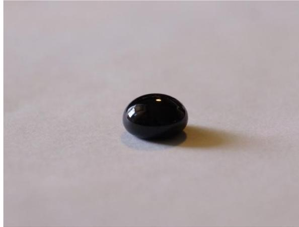
Рисунок Б4 - Образец шлакового расплава состава, % масс.: 39,7 – SiO<sub>2</sub>, 26,3 – CaO, 3,9 – MgO, 3,5 Al<sub>2</sub>O<sub>3</sub>, 20 Fe<sub>2</sub>O<sub>3</sub>, 2,29 P<sub>2</sub>O<sub>5</sub> после расплавления при T=1500 °С, продувке Ar в течение 20 мин, основность B=0,7
