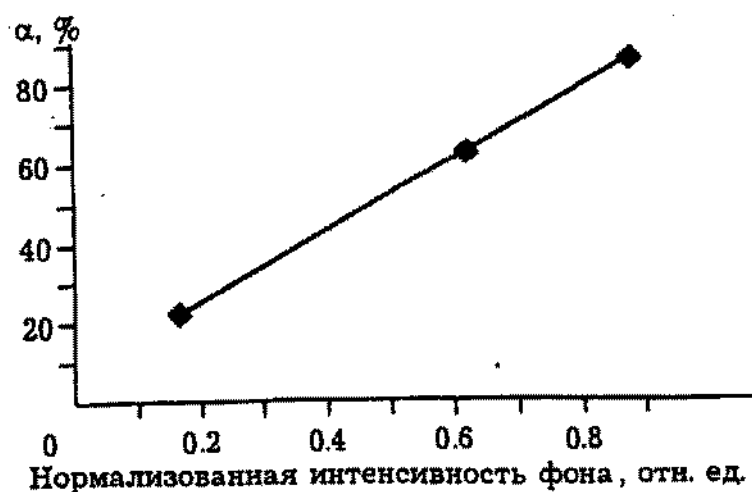
Рис. 1.8 – Зависимость степени извлечения циркония из механоактивированного циркона от нормализованной интенсивности фона [89]
