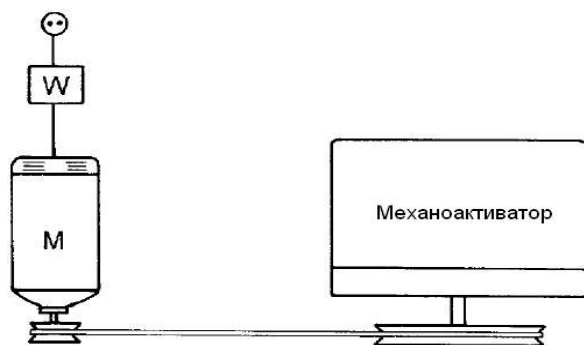
Рис.1.5 – Схема эксперимента по измерению мощности электродвигателя (М - двигатель) [73] обработки между разными барабанами, подчас встречающиеся на практике.
