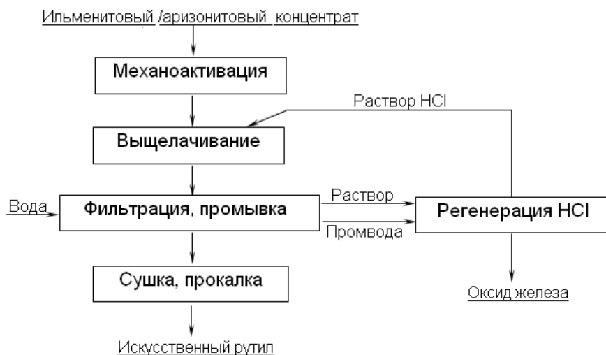
Рис. 6.7 – Принципиальная схема энергосберегающего солянокислотного производства искусственного рутила из механически активированных ильменитовых и аризонитовых концентратов
