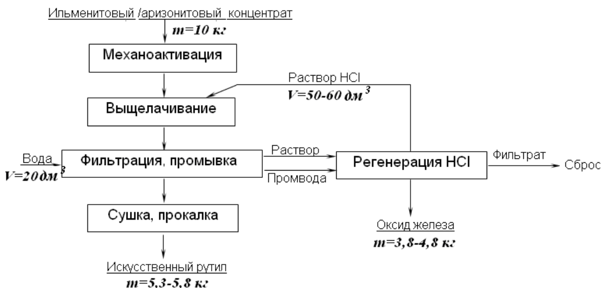
Рис.6.8 – Технологическая схема энергосберегающего солянокислотного производства искусственного рутила из механически активированных ильменитовых и аризонитовых концентратов (цифры относятся к объему реактора для выщелачивания 0,1 м³)
