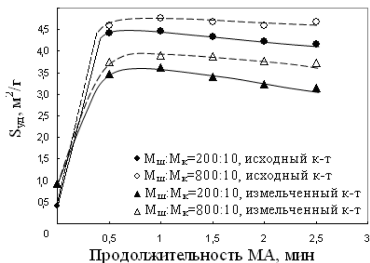
Рис. 5.3 – Изменение удельной поверхности низкосортного вольфрамитового концентрата после МА в «сухом» режиме
