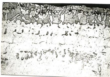
Рис. 7. Структура сплава ЖС6ФНК с покрытием системы NiCrAl после вакуумного отжига при температуре 1050°C в течении 30 часов (x500)
